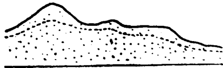
Fig. 92. — Nivelul hidrostatic al apei subterane, față de suprafața uscatului regiunii.
