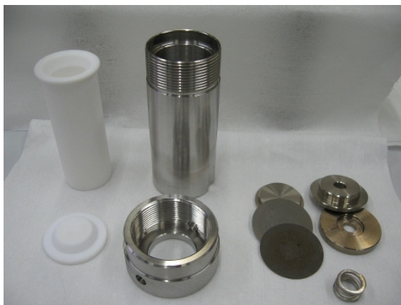
Fig. 2.2. Autoclavă de teflon prevăzută cu manta de oțel
