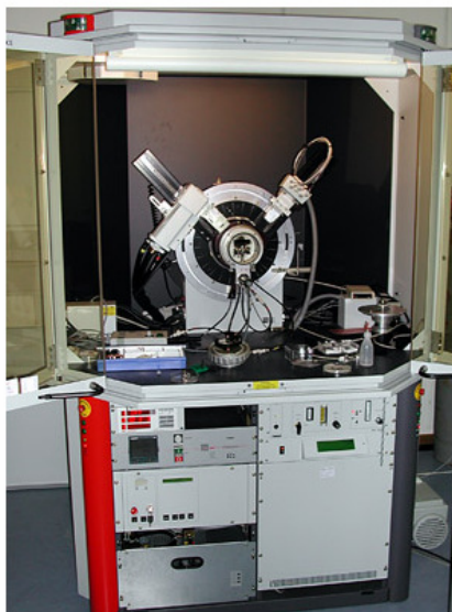
Fig. 3.2. Difractometrul Bruker AXS D8 Advance
