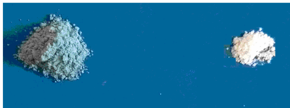
Fig. 4.6. Imaginile probelor de \text{NaTaO}_3 dopate cu ioni metalici de Cu sau Al obținute prin metoda ultrasonării
