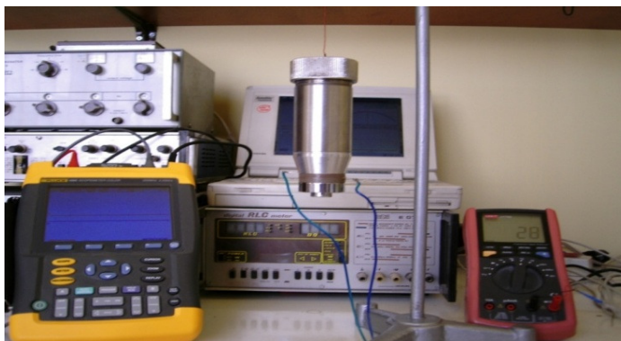
Fig. 2.3. Instalație experimentală de obținere a nanoparticulelor prin metoda hidrotermală asistată ultrasonic
