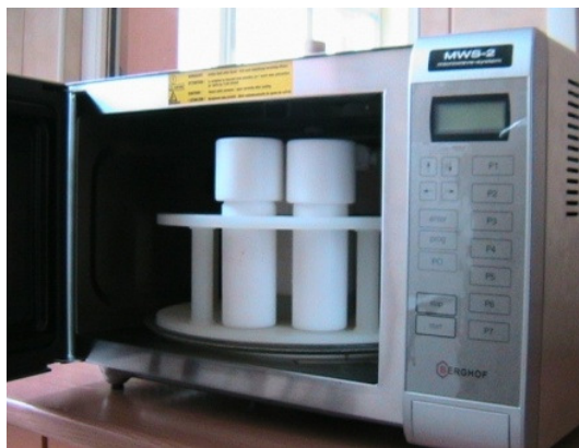
Fig. 2.4. Montaj experimental aferent metodei hidrotermale în câmp de microunde
