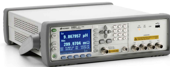
Fig. 3.8. RLC - metru de tip Agilent (E4980A)
