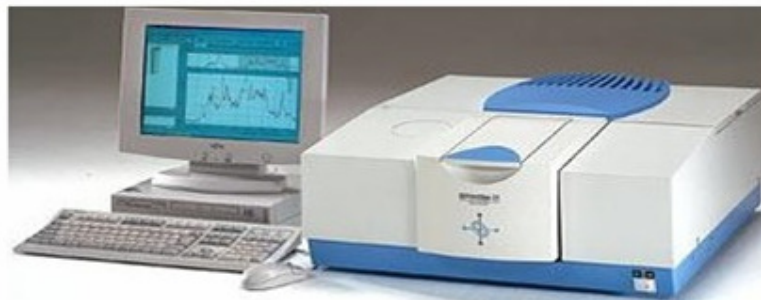
Fig. 3.4. Spectrometrul Shimadzu IR Prestige-21 (imagine de ansamblu)
