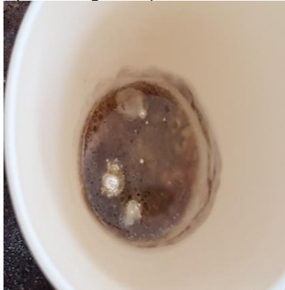
Fig.5.20. Aspecte după topirea rezidului, cu formarea perlei de borax
