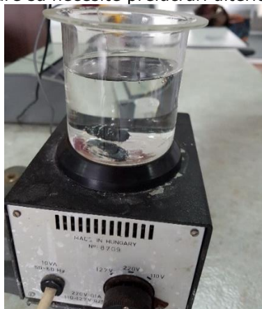
Fig.5.26. Instalația de agitare inductivă
