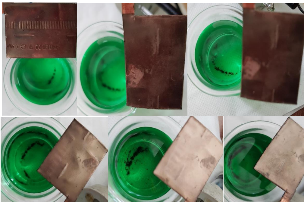
Fig.5.67. Aspecte privind depunerea de materiale pe catodul din Cu și cantitatea de Ag cementată în electrolizor
