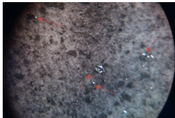
Fig.5.24. Filtrat obținut prin reducerea cu glucoză; vizualizare la microscop 20x
