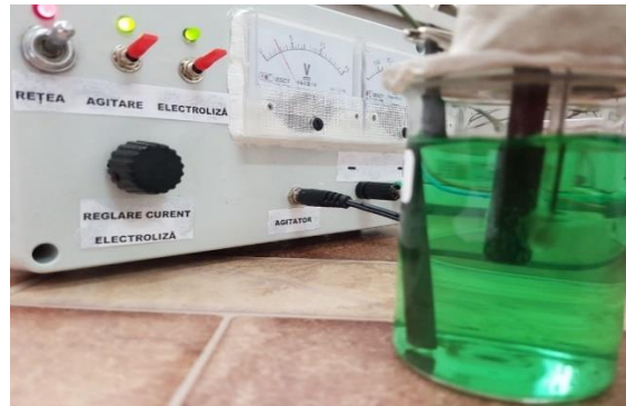
Fig.5.64. Instalația de electroliză prevăzută cu electrozi din grafit (catod respectiv anod)
