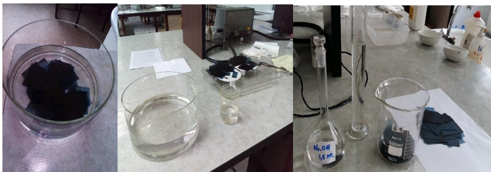
Fig.5.2. Pregătirea filmului radiografic (spălare, uscare, tratare cu NaOH 1,5M)
