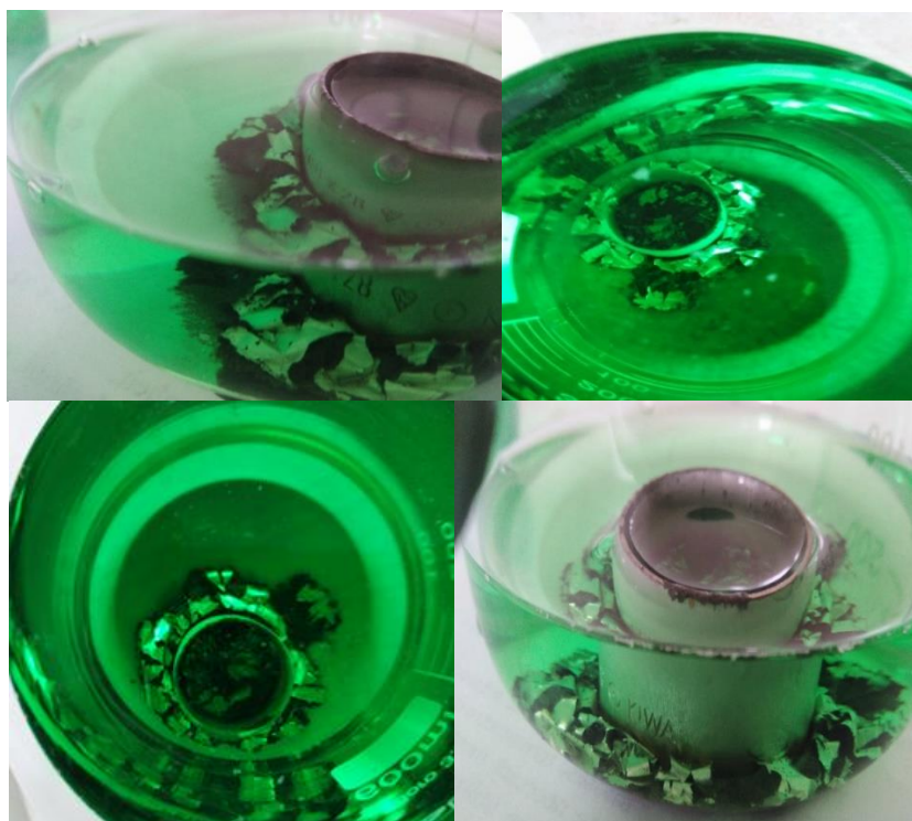
Fig.5.53. Formarea argintului atât sub formă de nanoparticule (cement) cât și sub formă de foiță de argint
