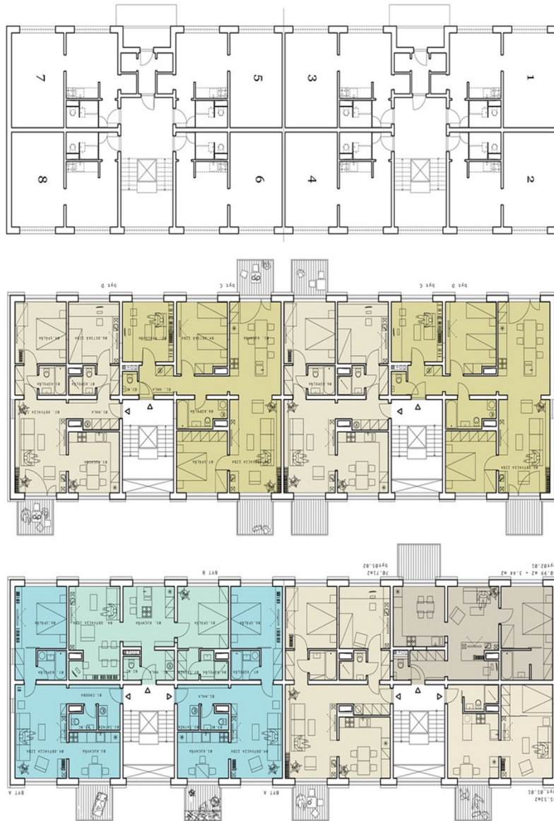
Fig. 5.9 Îmbunătățirea mixturii de locuințe prin reconfigurarea spațiului: Rimavska Sobota, Slovacia – situația inițială vs. situația după reabilitare Sursă: http://www.archdaily.com/602181/prefab-house-in-rimavska-sobota [103]
