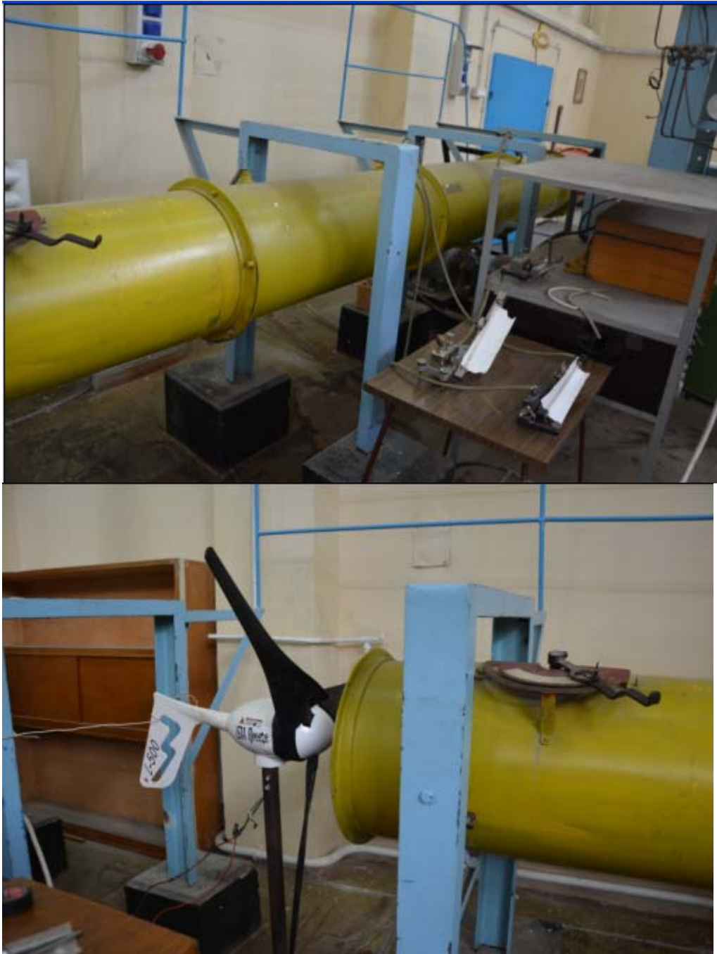
Fig.11.3 Dispozitivul pentru reglarea și măsurarea vitezei vântului.
