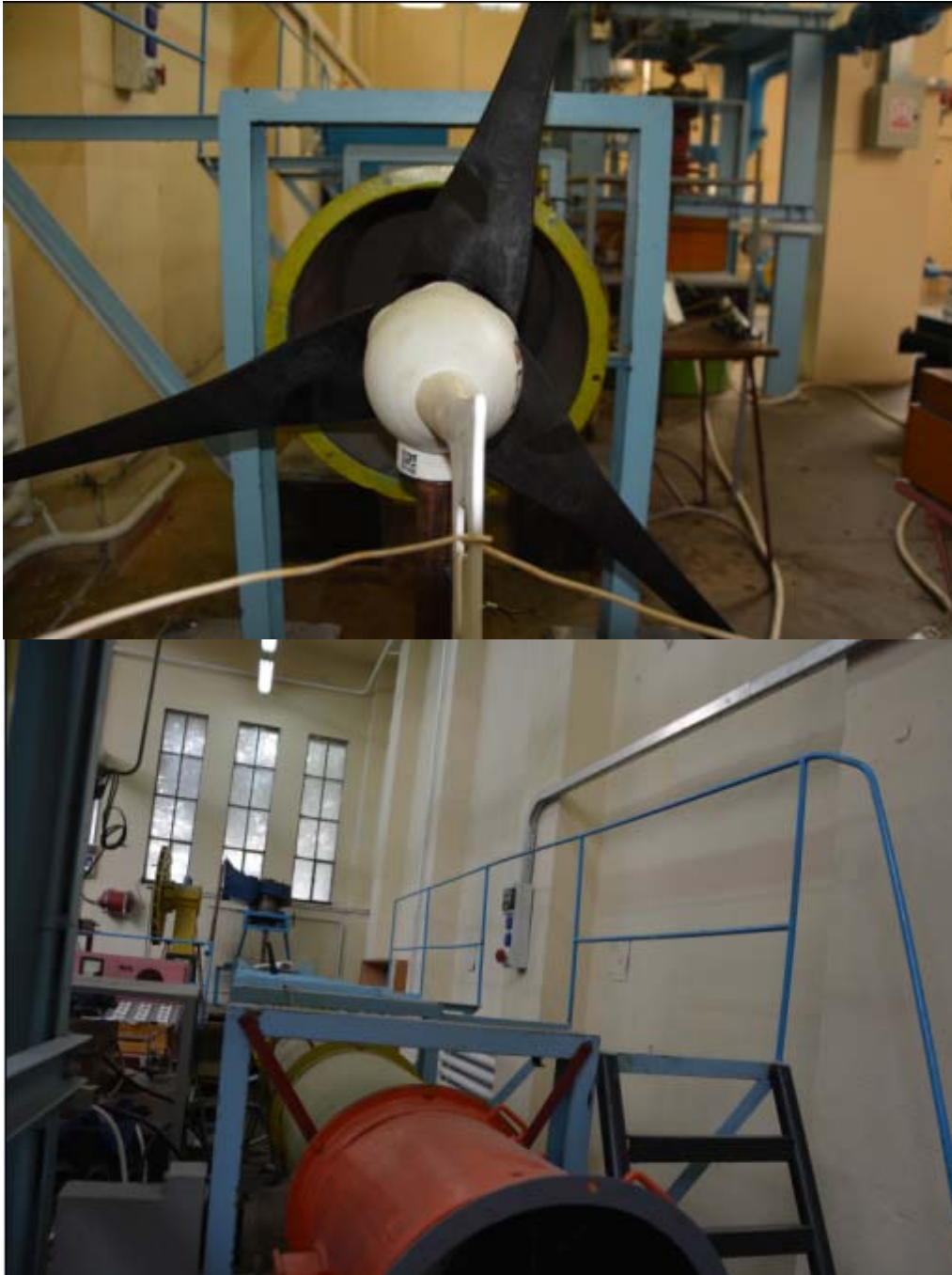
Fig.11.2 Vedere generală a tunelului aerodinamic și TV
