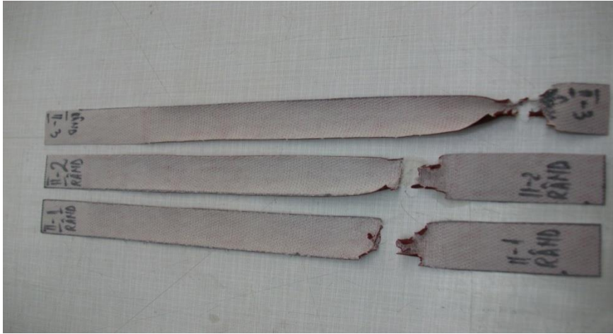
Fig.4.32. Imagini cu epruvetele din materialul compozit cu matrice din PVC (degradate cu radiații UV timp de 550 ore) prelevate pe direcția rândului de tricot, după încercarea la tracțiune
