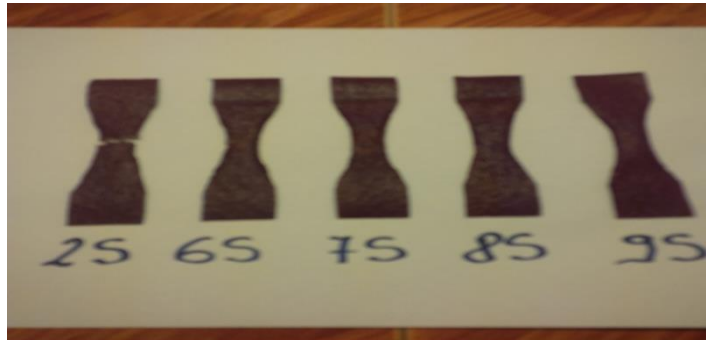
Fig. 4.46. Imagine de ansamblu cu epruvetele degradate cu UV cu nivel ridicat de radiații timp de 14 ore, pregătite pentru încercarea de oboseală la tracțiune oscilant pozitivă.
