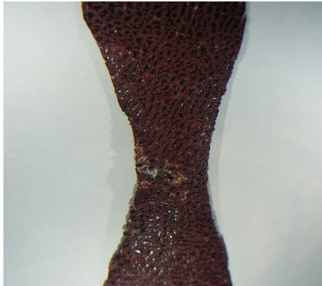
Fig.4.50. Imagine de detaliu cu epruveta S6 după încercarea de oboseală
