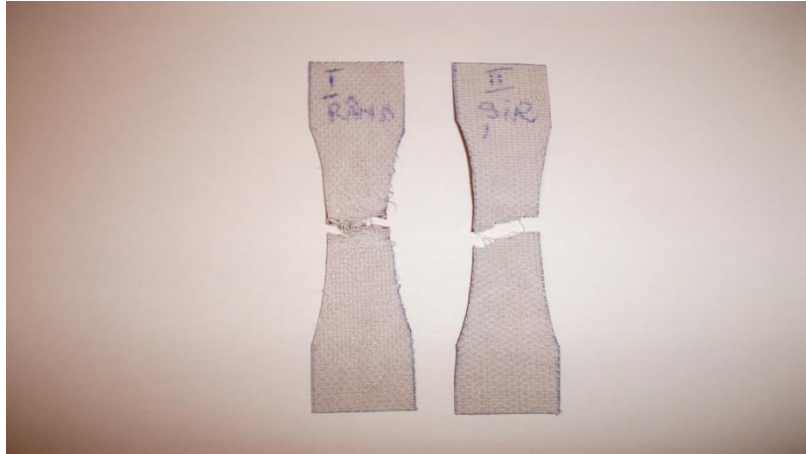
Fig.4.41. Imagini cu epruvetele prelevate din materialul compozit cu matrice din PVC degradat cu radiații UV timp de 14 ore, pe direcția șirului și a rândului de tricot, după încercarea la tracțiune
