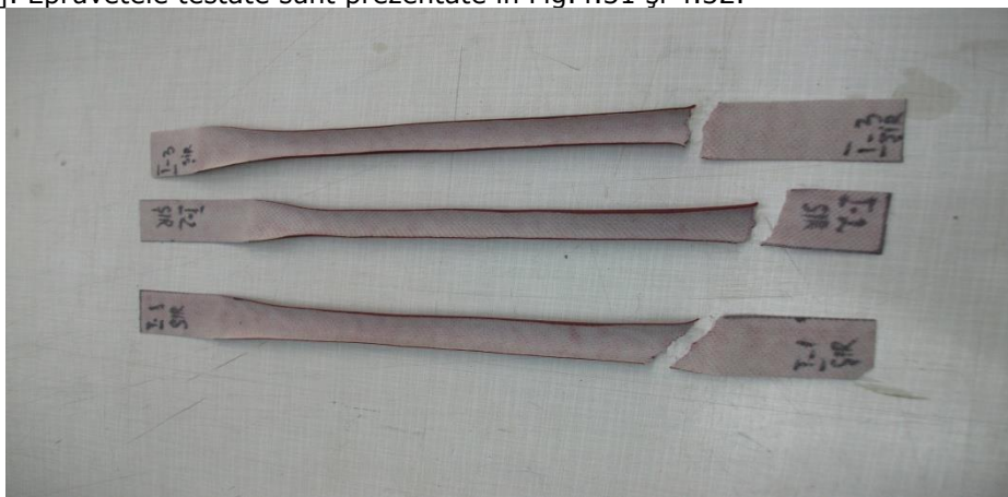
Fig.4.31. Imagini cu epruvetele extrase din materialul compozit cu matrice din PVC degradat cu radiații UV timp de 550 ore, pe direcția șirului de tricot, după încercarea la tracțiune
