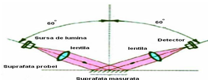
Fig. 2.19. Schema de principiu a unui aparat destinat măsurării lucii unei suprafețe [Roșu, D., 2011]
