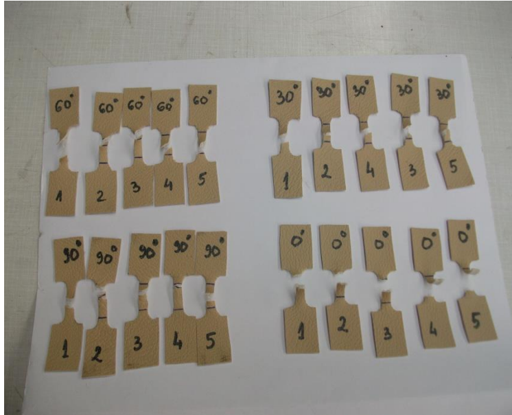
Fig.3.9. Imagini cu secțiunile de rupere pentru epruvetele de material cu PU după testarea la tracțiune
