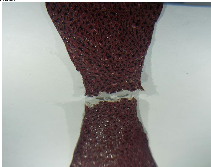
Fig.4.49. Imagine de detaliu cu epruveta S2 după încercarea de oboseală
