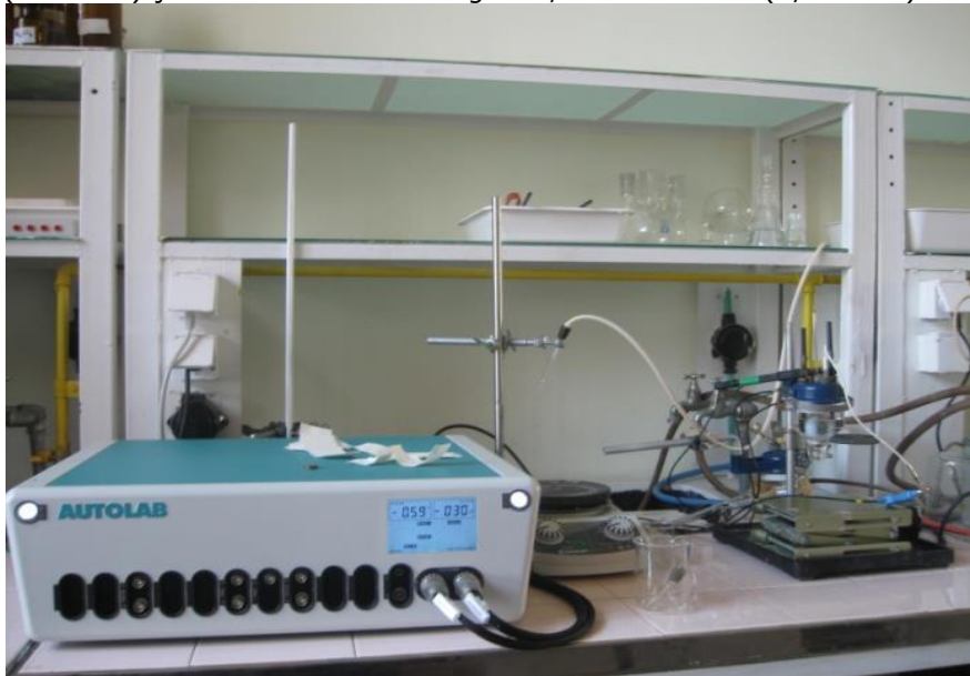
Fig. 4.1. Instalația folosită pentru determinarea comportamentului la coroziune
