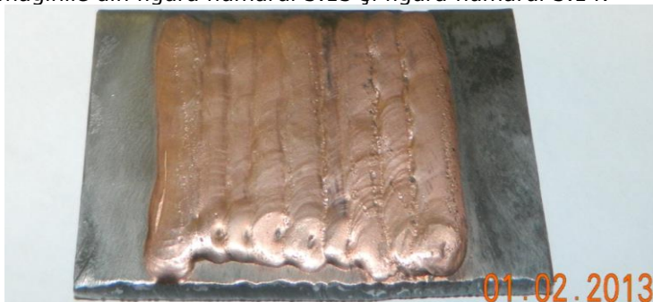
Fig. 3.13. Strat Cu depus prin sudare WIG
