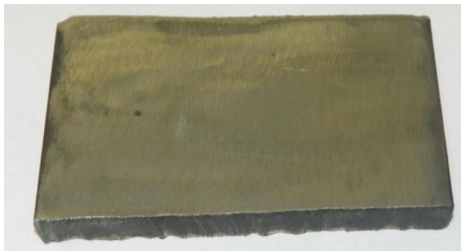
Fig. 3.3. Aspectul probelor înainte de depunerea prin sudare WIG
