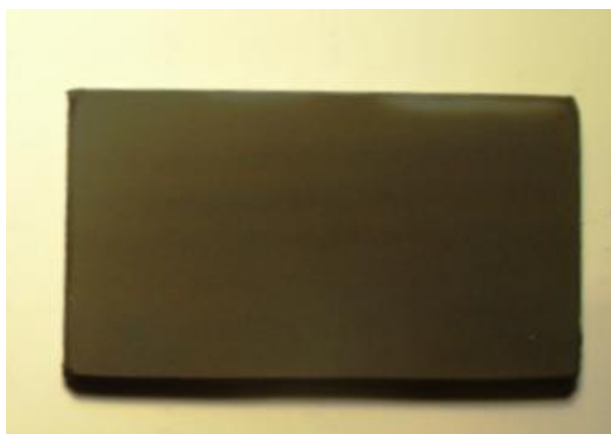
Fig. 2.14. Pulbere de Ti depusă prin metoda HVOF pe substrat din oțel nealiat
