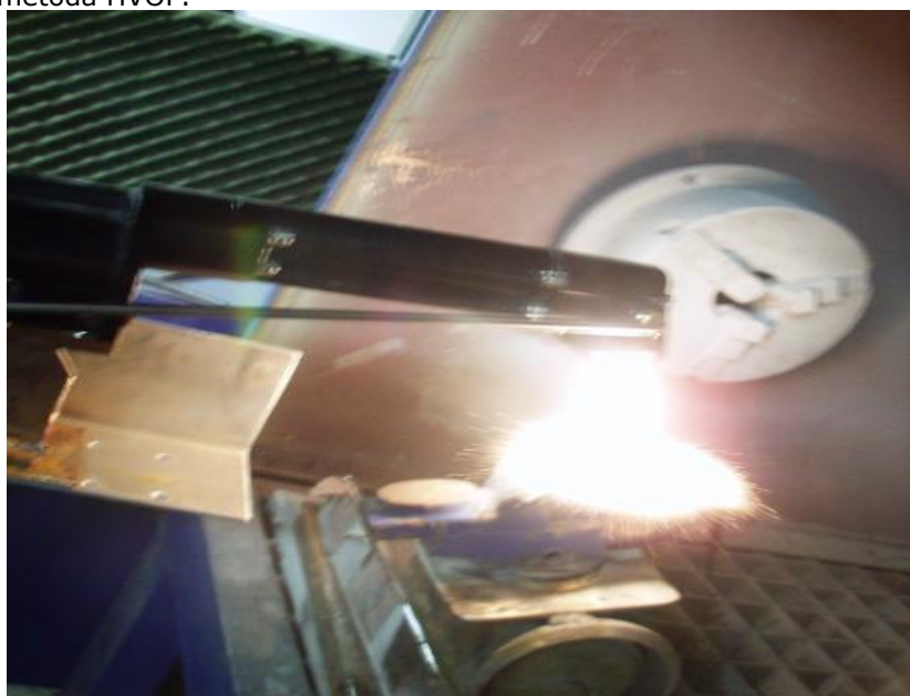
Fig. 2.13. Imagine din timpul procesului de pulverizare termică cu metoda HVOF
