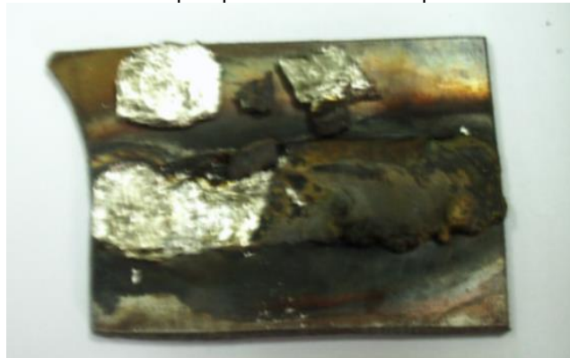
Fig. 3.17. Defecte tehnologice a statului de titan depus prin sudare
