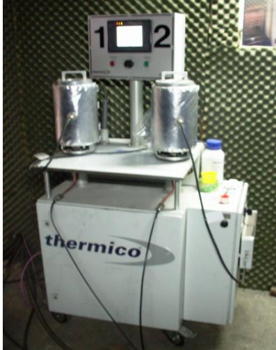
Fig. 2.9. Dozatorul de pulbere
