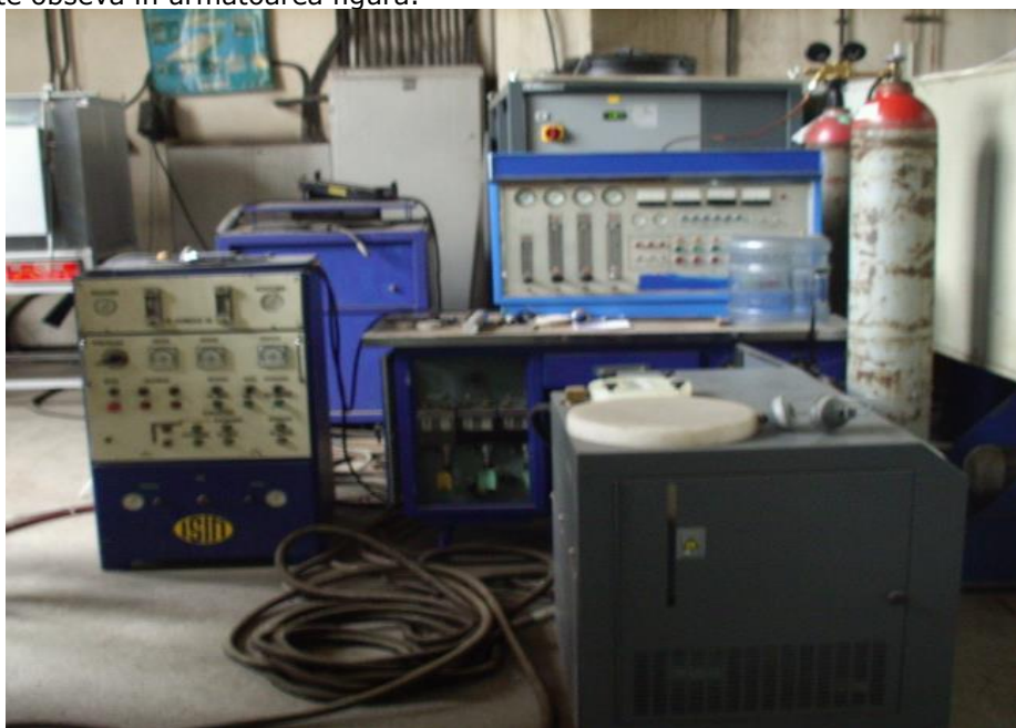
Fig. 2.8. Alimentarea cu oxigen și gaz combustibil a instalației HVOF
