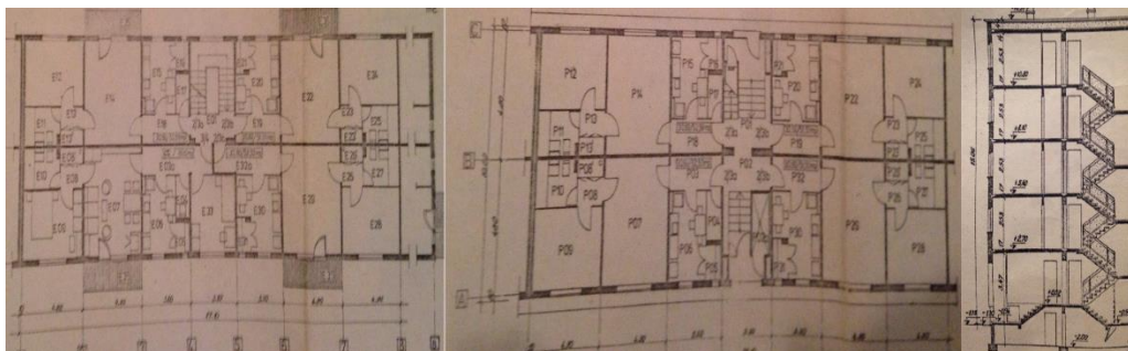
Fig.5.7. Proiectul tip T744-IPCT Db1. De la stânga la dreapta, plan etaj, plan parter și secțiune verticală.
