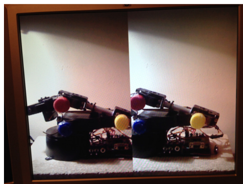
Fig. 4.24 Imaginea stereo a brațului robotic pe monitor captat cu placa FPGA ATLYS și camera stereo VmodCAM
