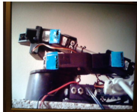
Fig. 4.4 Recunoaștere culorii albastre cu ajutorul FPGA ATLYS – programare în VHDL
