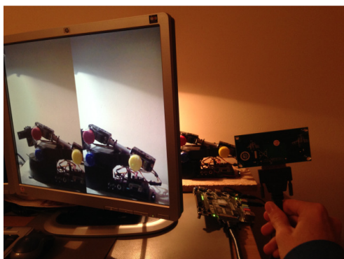
Fig. 4.23 Achiziția imaginii stereo cu placa FPGA ATLYS – programare în VHDL
