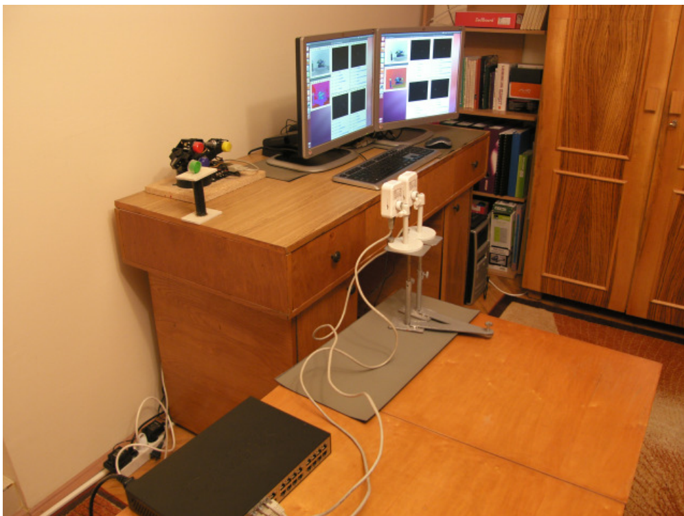
Fig. 4.36 Experimentul pentru controlul brațului robotic Lynxmotion AL5B în 3D cu detecție de markeri folosind camera IP în C cu OpenCV sub Linux
