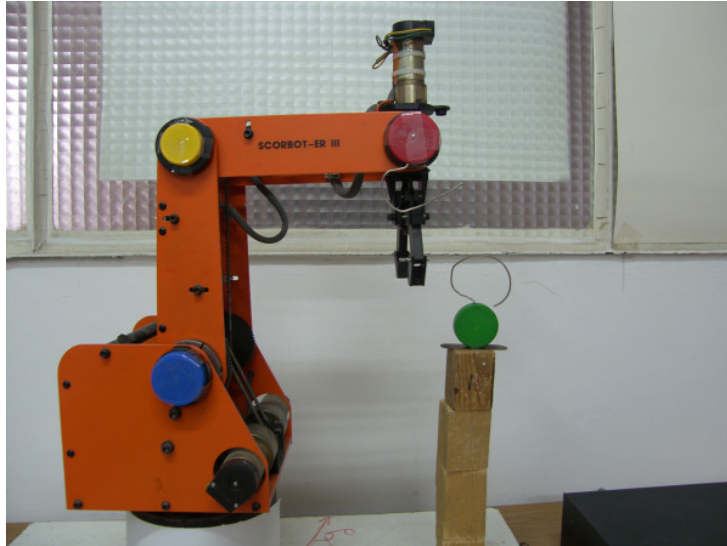
Fig. 3.4 Dopuri mai mari colorate aplicate în puncte cheie și la punctul țintă ale brațului robotic SCORBOT-ER III (dopul este vizibil și când brațul robotic este perpendicular pe camerele video)
