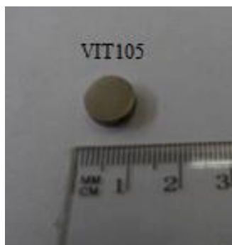
Figura 4.29 Materialul formă de pastilă obținut prin presarea la cald a pulberilor metalice amorfе din compoziția Zr_{52.5}Cu_{17.9}Ni_{14.6}Al_{10}Ti_5 (Vitrelloy 105)
