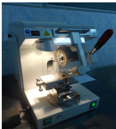
Figura 4.9 Dispozitiv prevăzut cu freză disc pentru debitarea aliajelor primare
