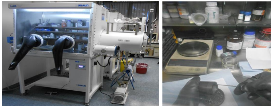
Figura 4.15 Echipamentul LABstar glove box-MBRAUN pentru pregătirea recipientelor și cernerea pulberilor
