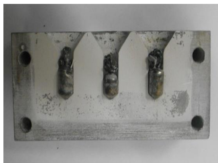
Figura 4.8 Aliajele primare pe baza de Fe turnate în matriță.
