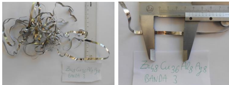
Figura 4.19 Banda din aliajul Zr_{48}Cu_{36}Al_8Ag_8 elaborate prin metoda Melt Spinning
