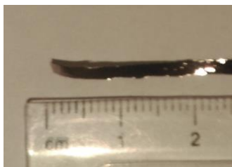
Figura 4.13 Banda din aliaj pe bază de Fe obținută prin metoda melt-spinning
