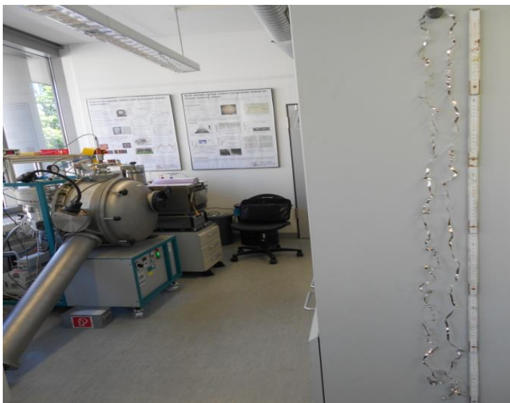
Figura 4.20 Aliajul de Zr_{48}Cu_{36}Al_8Ag_8 sub formă bandă cu o lungime de 2.4 m elaborată prin metoda melt spinning alături de instalația Bühler
