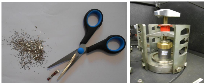
Figura 4.21 Benzile tăiate manual cu foarfeca (stânga) și recipientul cu benzile de măcinat (dreapta)
