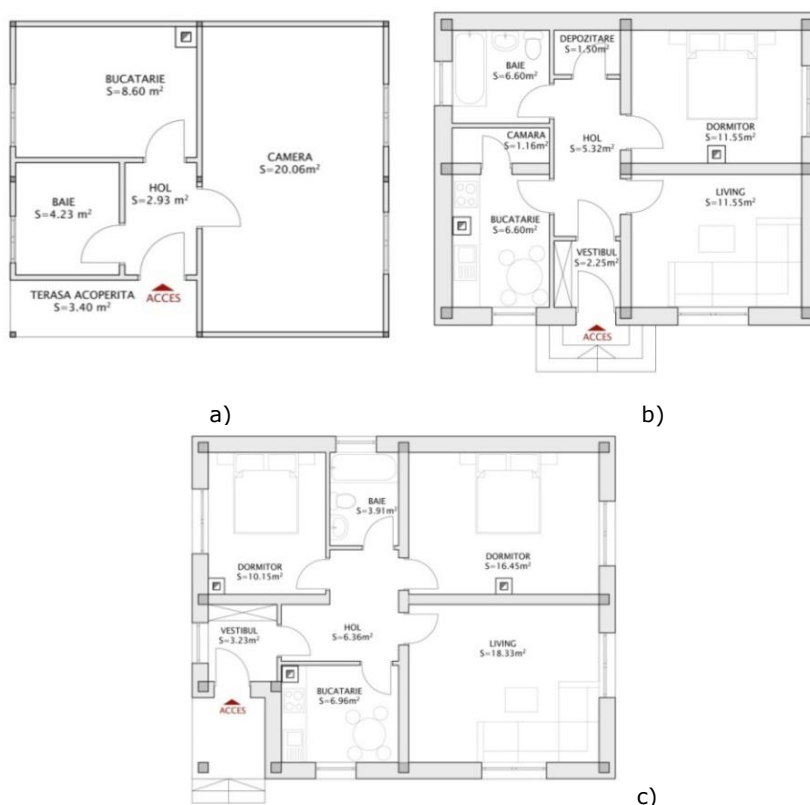
Fig. 3.8. Tipologii de proiecte de case: a) cu o cameră, b) cu două camere, c) cu trei camere
