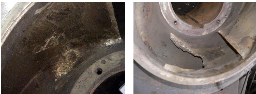
Fig. 5.14 Rotor de pompă de acumulare erodat cavitațional
