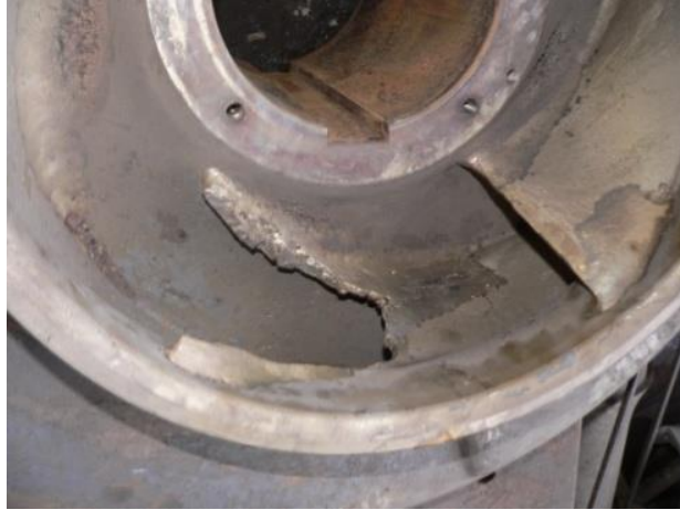
Fig. 1.8 Rotorul pompei PRO 10-195 ce echipează SP Jidoaia, erodat cavitațional
