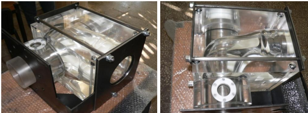
Fig. 3.1 Secțiunea cot realizată din plexiglass
