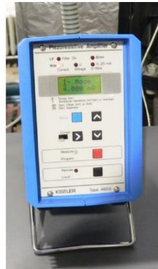
Fig. 1.24 Amplificatorul piezorezistiv de presiune [59]
