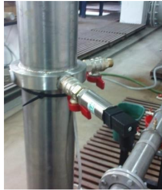
Fig. 1.12 Traductor de presiune manometric
