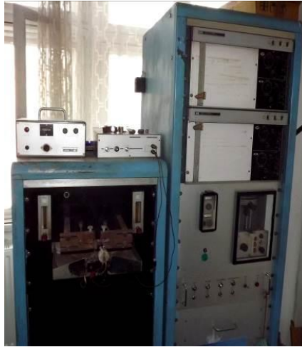
Fig. 3.19. Simulator de sudură Smitweld LS 14o2
