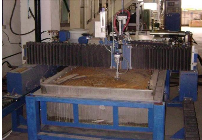
Fig. 3.7. Instalație de tăiere cu jet de apă Streamline SLV OEM 30HP
