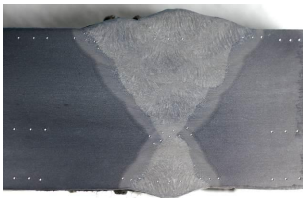
Fig. 3.32. Imagine macroscopică cu urmele din zonele caracteristice îmbinării sudate, după realizarea încercării de duritate HV10
