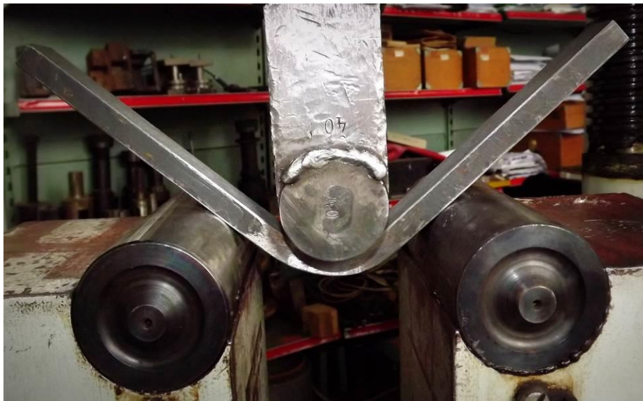
Fig. 3.54. Încercarea de îndoire transversală laterală
