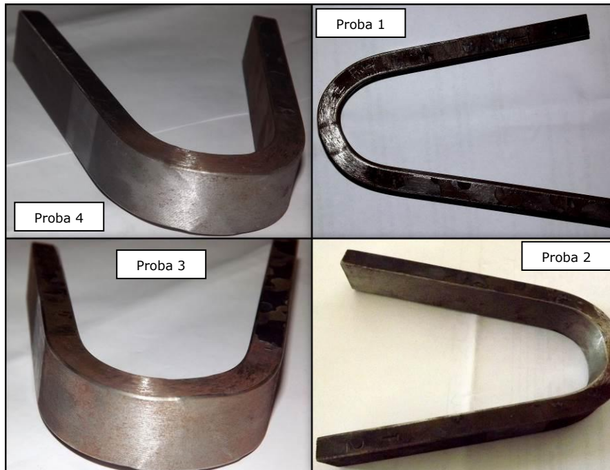
Fig. 3.55. Imagini ale epruvetelor supuse la îndoire transversală laterală
