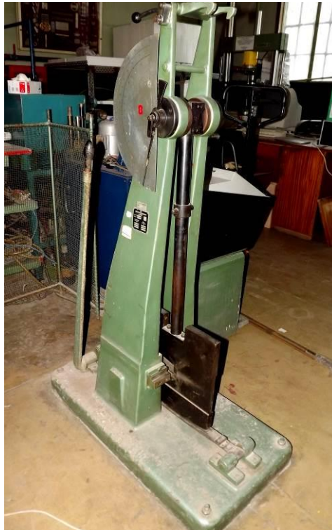
Fig. 3.45. Ciocan pendul tip Charpy PSW30
