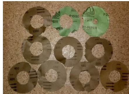
Fig. 3.3. Tipuri de hârtie abrazivă folosită pentru pregătirea suprafețelor
