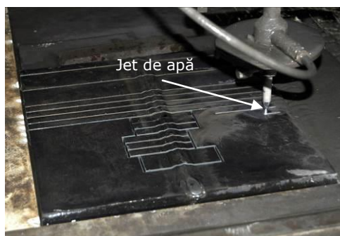
Fig. 3.16. Tăierea cu jet de apă a plăcii din oțel marca P355NH
