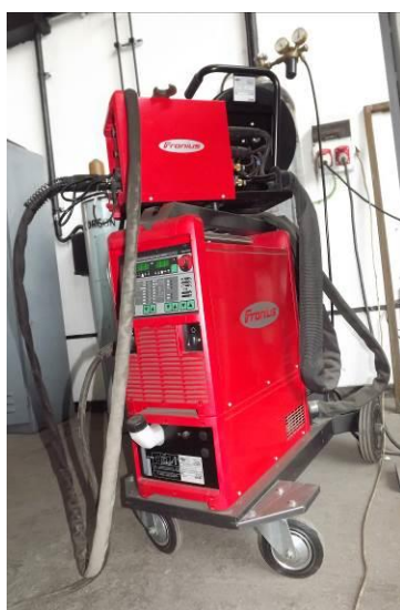
Fig. 3.10. Instalația de sudare MIG-MAG Fronis TransPlus Synergic 5000
