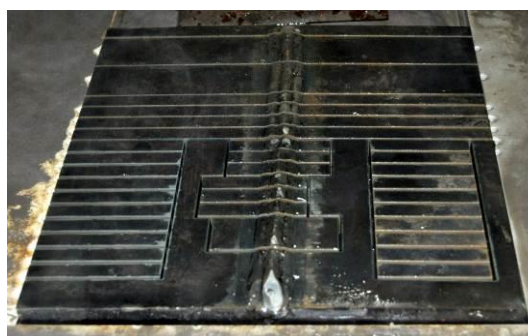
Fig. 3.17. Placa din oțel marca P355NH tăiată cu jet de apă
