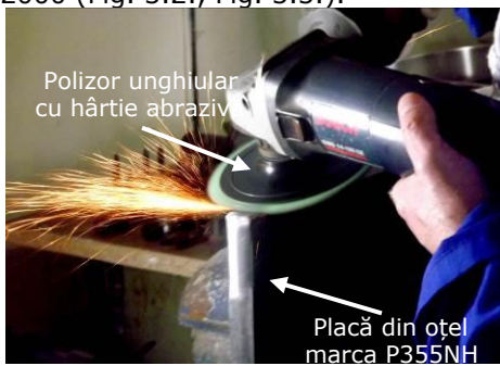
Fig. 3.2. Pregătirea suprafețelor utilizând polizorul unghiular cu hârtie abrazivă
