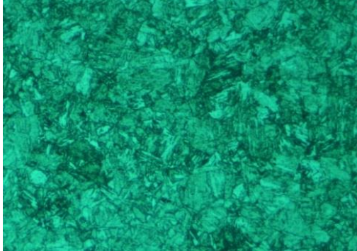
Fig. 3.30. Examinarea microscopică a probei simulate cu cicluri termice cu tratament post-simulare, în ZITS [Atac Nital 2%, 100X]
