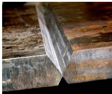
Fig. 3.9. Imagine rost de sudare în X
