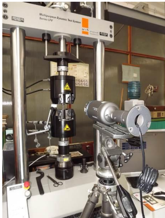
Fig. 3.35. Mașina universală de încercat la tracțiune-compresiune model w+b LFV-100 HH
