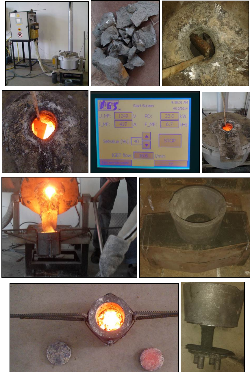
Fig.6.1.A. Aspecte din timpul elaborării fontei în cuptorul cu inducție
