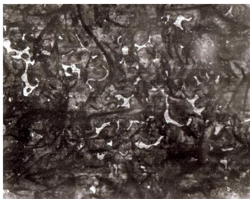
Fig.3.3. Modul de repartizare a eutecticului fosforos în fontele cenu ii, (200:1)
