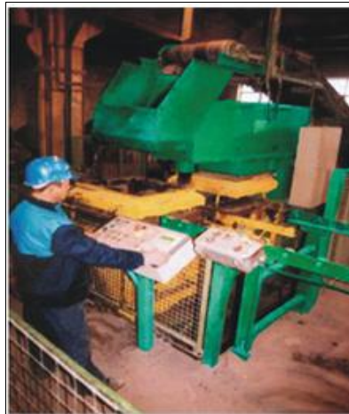
Fig.3.14. Mașina de format tip HFP2
