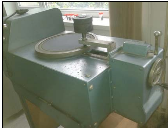
Fig.7.2. Instalație pentru încercarea la uzare abrazivă
