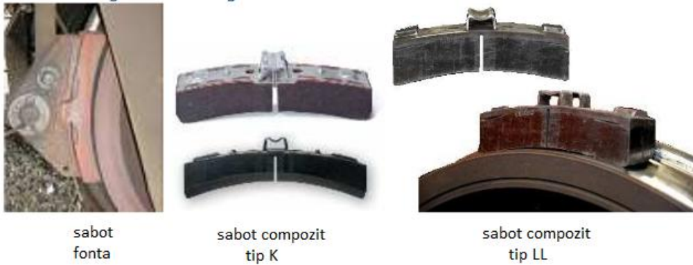
Fig.3.16. Variet ile de sabo i utiliza i pe vehiculele feroviare, [40]
