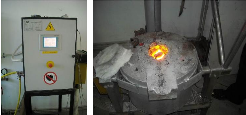
Fig.6.3. Cuptor cu induc ie, capacitate 10 kg
