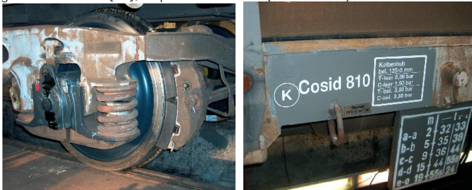
Fig.3.17. Imagine a vagonului modernizat cu sabot tip K, [41]
