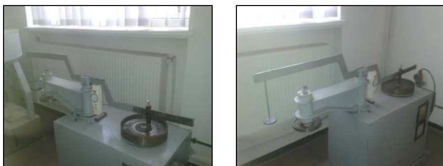
Fig.7.72. Stand de laborator pentru studiul uzurii prin metoda știft pe disc
