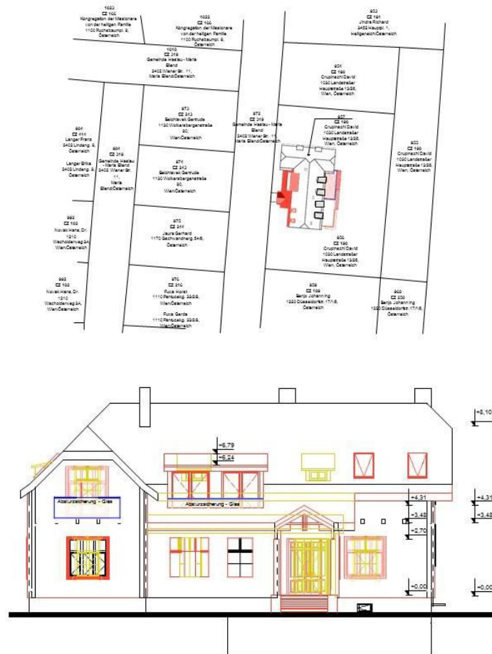
Fig 49 - Planul de situație și fațada principală a clădirii asupra căreia s-a realizat unul din studiile de caz din actuala teză, clădire situată în localitatea Maria Ellend, landul Austria Inferioară. Culoarea galbenă marchează elementele ce au fost înlăturate, culoarea roșie marchează elemente noi.
