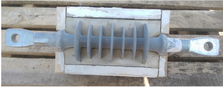
Figura 4.56. Matrița și izolatorul electric
