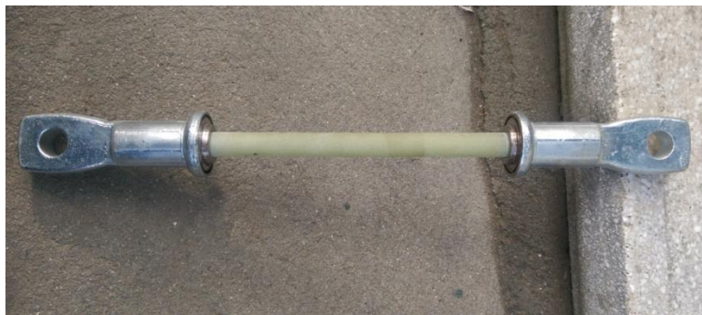
Figura 4.53. Tija izolatorului electric și capetele de armare
