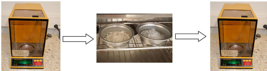
Figura 3.9. Determinarea ratei umidității armăturilor
