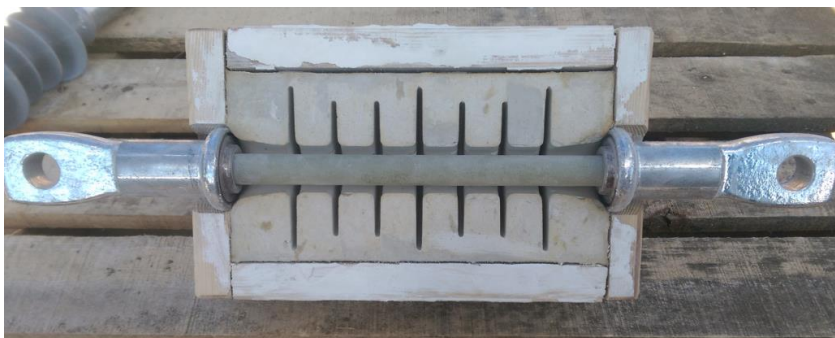
Figura 4.55. Matrița și tija izolatorului electric pregătite de turnare
