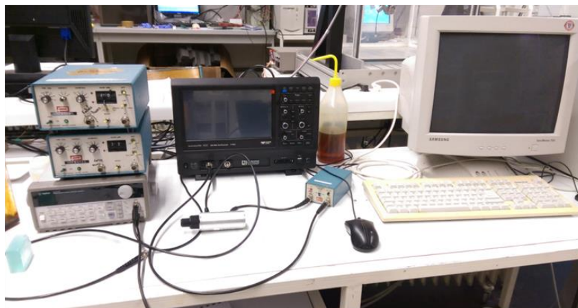
Figura 3.25. Echipamente pentru realizarea încercărilor ultrasonice
