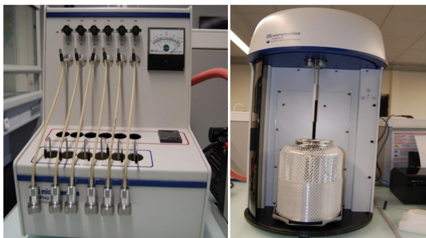
Figura 3.3 BET Tristar II analizor de suprafață specifică
