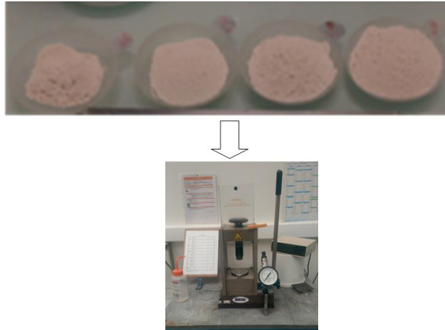
Figura 4.1 Modul de preparare a pastilelor de argilă
