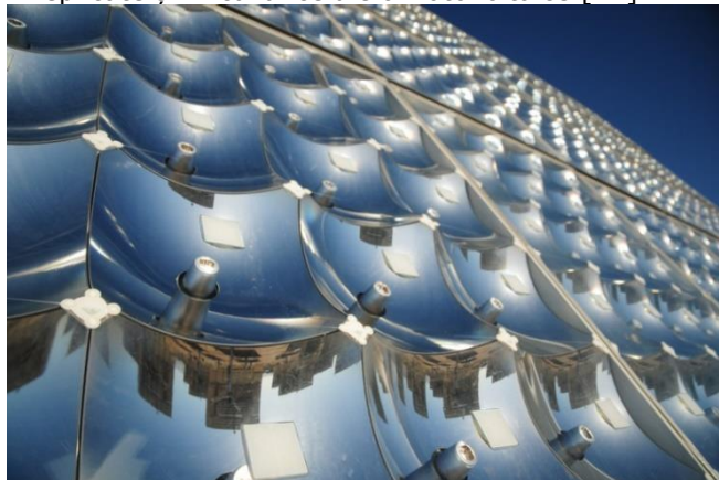
Figura 2.20. Panouri solare cu celule fotovoltaice concentrate [12]
