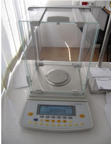
Fig. 2.6 Balanță electronică cu patru zecimale
