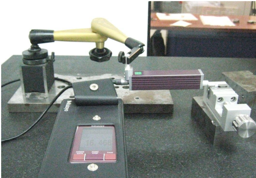
Fig. 2.14 Aparatul Mitutoyo pentru măsurarea rugozității (foto: Lavinia Mădălina Micu)
