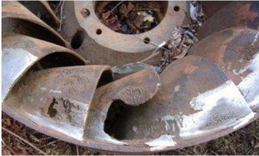
Fig. 1.8 Rotorul Francis distrus prin eroziune cavitațională [171]
