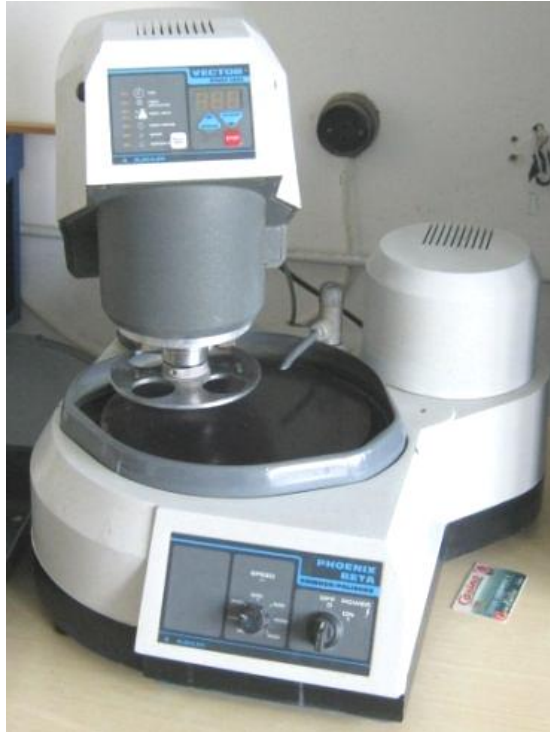
Fig. 2.5 Instalația Buehler Phoenix Beta pentru șlefuire – lustruire (foto: Lavinia Mădălina Micu)
