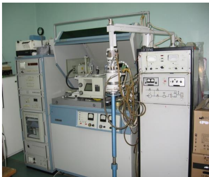
Fig. 3.42. Echipamentul de difracție cu raze X, Dron 3
