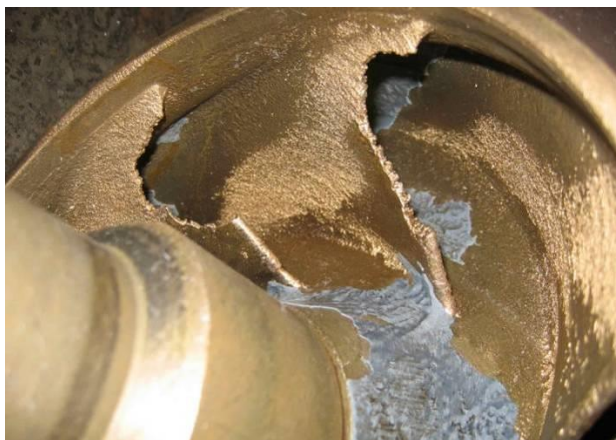
Fig. 1.11 Rotorul de pompă distrus prin eroziune cavitațională [173]
