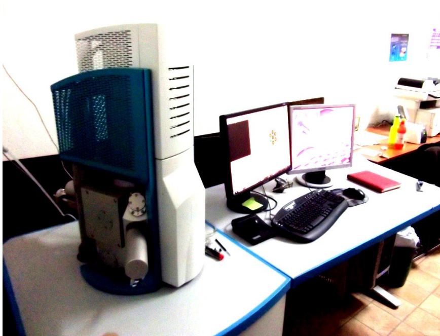
Fig. 2.11 Microscopul electronic cu baleiaj TESCAN VEGA 3 LMU Bruker EDX Quantax (foto: Lavinia Mădălina Micu)
