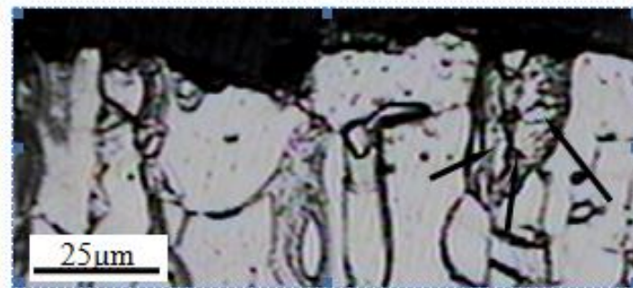
Fig. 3.38 Proba S1: a - aria investigată EDX; b - rețea de microfisuri pe suprafața probelor cavitate (dezvoltate în grăunții de ferită)
