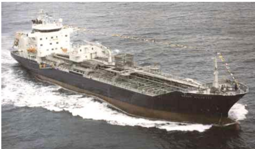
Fig. 1.5 Nave marine, tip cisterne pentru transport substanțe chimice, din oțel 2205 (source: Krupp, Thyssen Nirosta)
