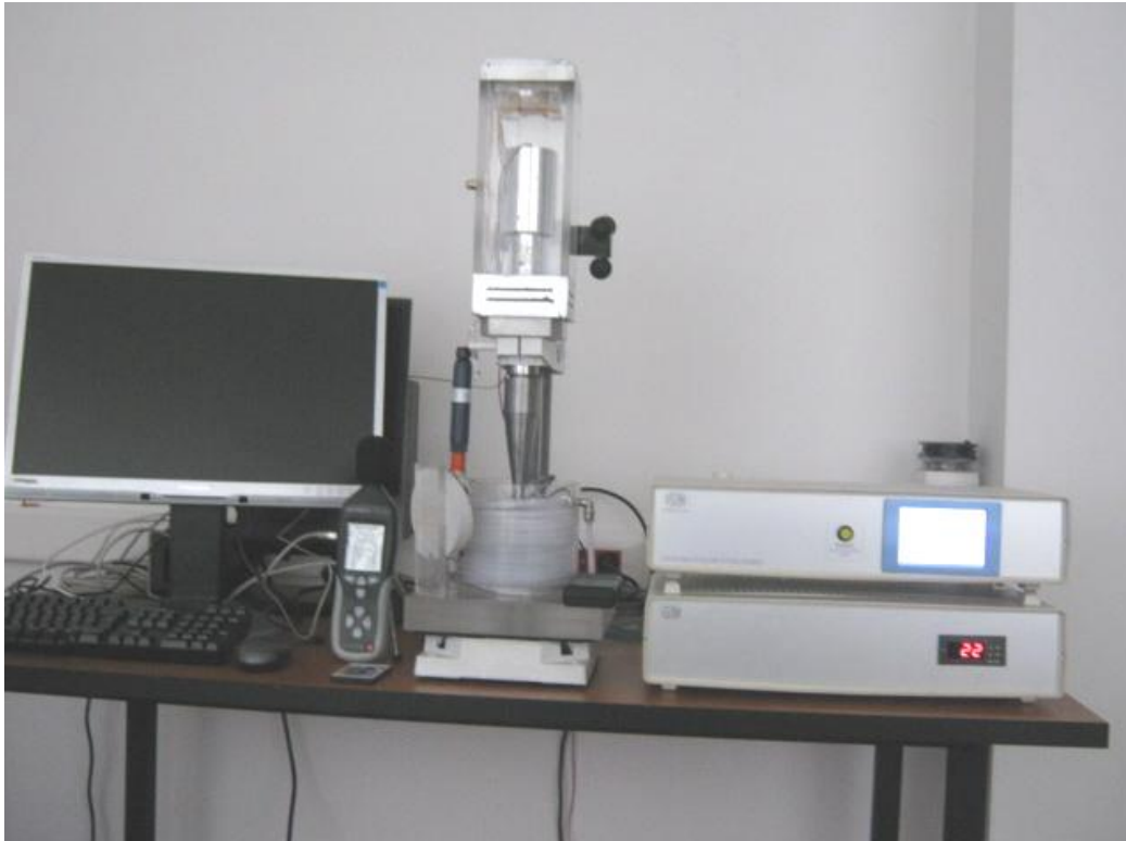
Fig. 2.4 Aparatul vibrator cu cristale piezoceramice (foto: Lavinia Mădălina Micu)
