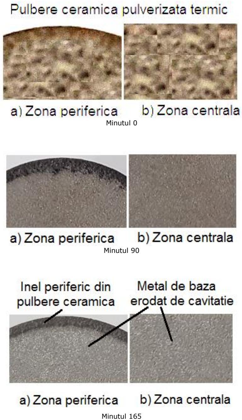
Fig. 5.7 Imagini ale degradării prin cavitația vibratoare a stratului din compozitul WC-9Co-5Cr-1Ni, depus HVOF
