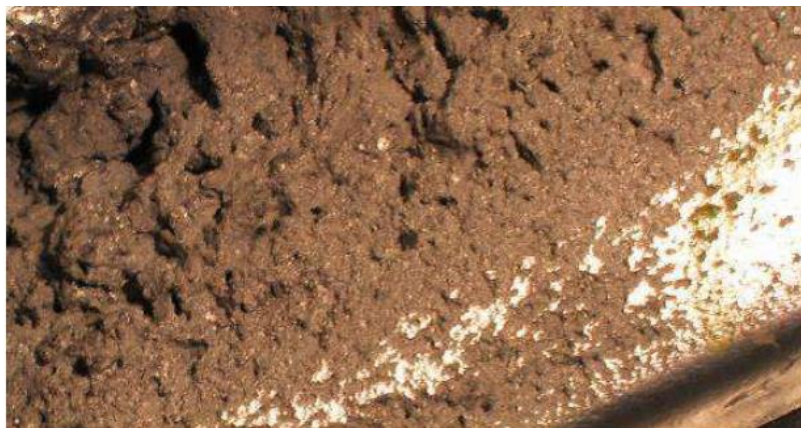
Fig. 1.10 Detaliu al unei zone afectate de eroziunea cavitațională pe o paletă a rotorului de la Porțile de Fier I [17]
