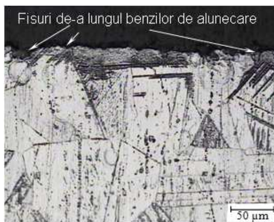
Fig.4.7 Imagine microscopică a degradării structurii în secțiune transversală (x 200; Călire 1000 °C/25 min/apă)
