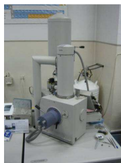
Fig.2.12 Microscopul electronic cu baleiaj Philips XL 30 ESEM (foto din laboratorul de Ingineria Materialelor)
