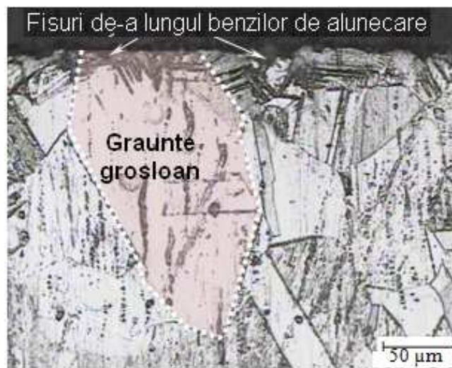
Fig.4.9 Imagine microscopică a degradării structurii în secțiune transversală (x200; Călire 1100 °C/25 min/apă)
