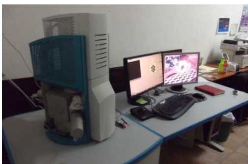
Fig.2.11 Microscopul electronic cu baleiaj TESCAN VEGA 3 LMU Bruker EDX Quantax (Foto din laboratorul de ingineria Materialelor)
