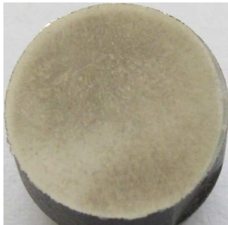
Fig.5.2 Imaginea suprafeței probei înainte de începerea atacului cavitației (minutul 0; R_a = 3,2 \mu\text{m} )
