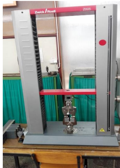
Fig.4.24 Echipamentul pentru efectuarea încercărilor mecanice, tip Zwick/Roell Z005 aflat în dotarea laboratorului de Rezistența materialelor de la Facultatea de Mecanică, Timișoara
