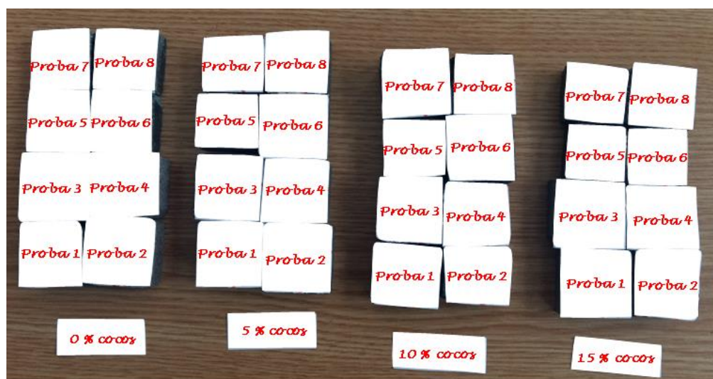
Fig.4.25 Eșantion de probe aparținând familiei de compozite F1, pregătite pentru efectuarea încercării mecanice de compresiune
