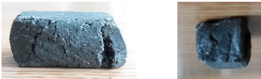
Fig.4.46 Epruvetă din familia F2 de materiale compozite realizată cu 5% fibră de nucă de cocos deformată ca urmare a solicitării de compresiune
