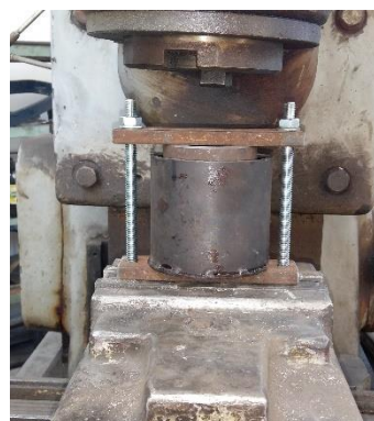
Fig.4.17 Presarea ansamblului probă-matriță cu ajutorul presei hidraulice PH 40
