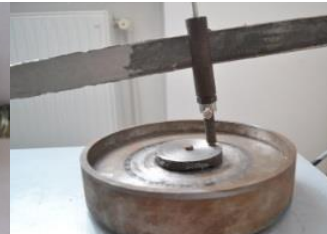
Fig.5.16 Cupla cinematică de testat montată în ansamblul instalației tribologice
