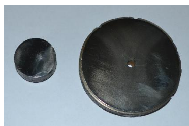
Fig.5.5 Eșantion de probe cilindrice polizate și șlefuite
