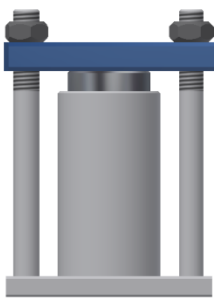
Fig. 4.3 Modelul 3D al matriței pentru realizarea epruvetelor de tip cilindru [66]
