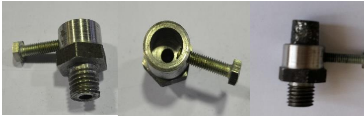
Fig.5.14 Suportul pentru montarea pinului din material compozit
