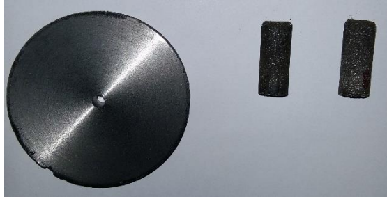
Fig.5.13 Probele disc realizate din fontă împreună cu pinii din compozit
