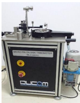
Fig.5.45 Tribometru TR-20 pentru determinare coeficientului de frecare
