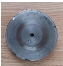
Fig.5.28 Imaginea discului din fontă la finalul încercărilor tribologice
