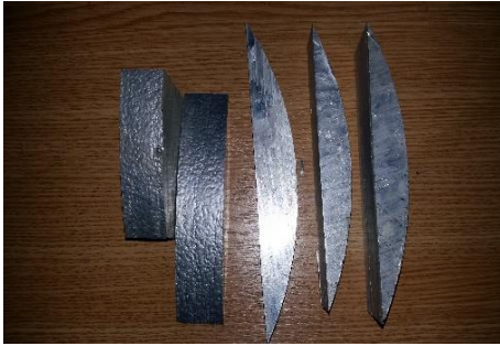
a-bucăți de aluminiu pregătit în vederea pilirii
