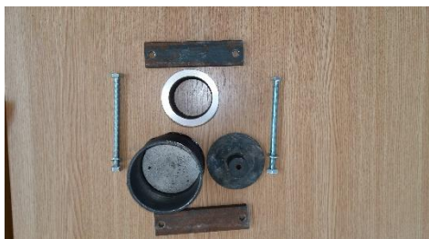
Fig.4.14 Elemente componente ale matriței nou concepute
