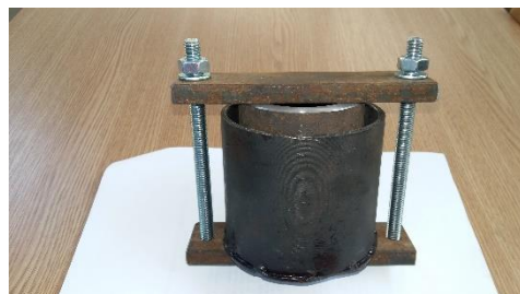
Fig.4.15 Soluția îmbunătățită a ansamblului matriței
