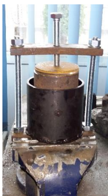
Fig.4.16 Strângerea pistonului matriței
