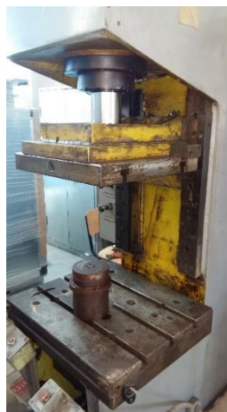
Fig.4.13 Presă electro-hidraulică tip PH 40
