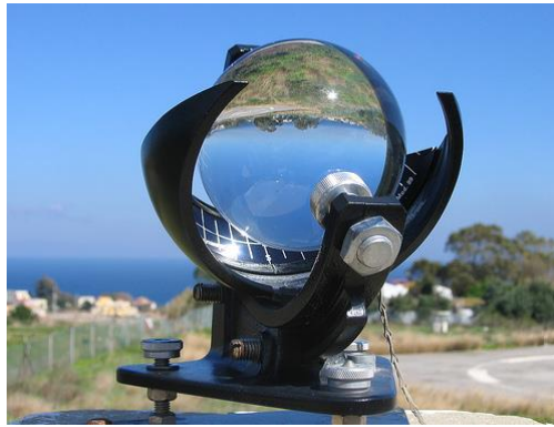
Fig. 4.4 (a) Heliograf Campbell-Stokes: (1) Sferă de sticlă.; (2) Suport pentru hârtia de înregistrare; (3) Suport cu mecanism de orientare după traiectoria Soarelui pe cer; (4) Suport cu reglaj al orizontalității; b. Fotografie a unui heliograf Campbell-Stokes [119] (după Paulescu et al. 2008)
