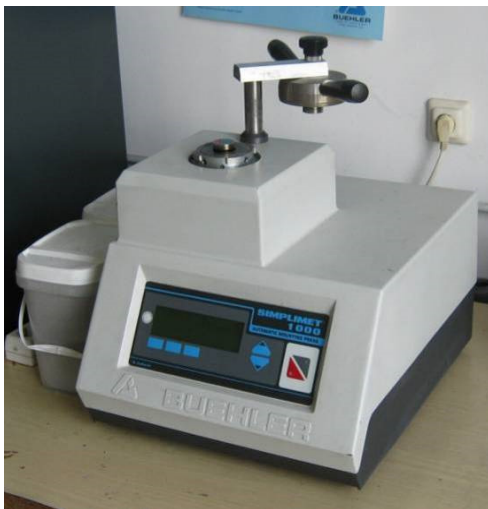
Fig. 2.7 Aparatul de înglobat la cald Buehler Simplimet 1000
