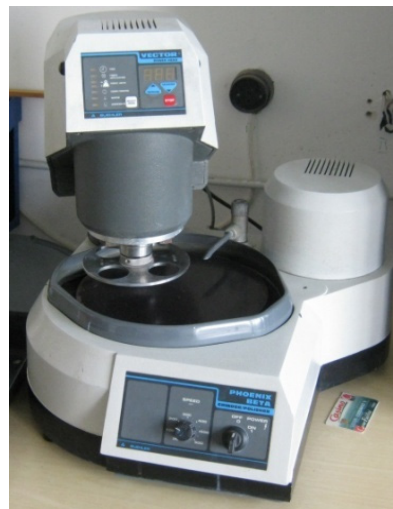
Fig. 2.8 Aparatul de șlefuit și lustruit Buehler Phoenix Beta
