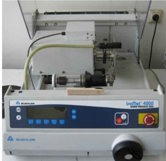
Fig. 2.6 Aparatul de tăiat cu pânză BUEHLER 4000
