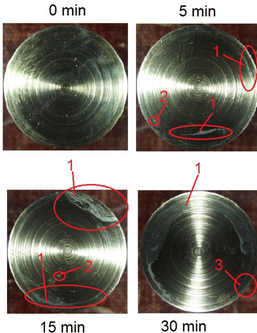
Fig. 5.21 Evoluțiile comportării la cavitația vibratoare a straturilor de amestec de tip 3 1- apă și bule între pelicula polimerică și suprafața metalică a probei de cavitație; 2-perforări în peliculă; 3- eroziuni (caverne și pittinguri) în suprafața metalică
