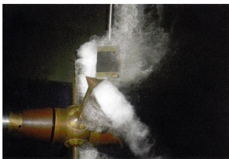
a) Elice în vârtej cavitațional
