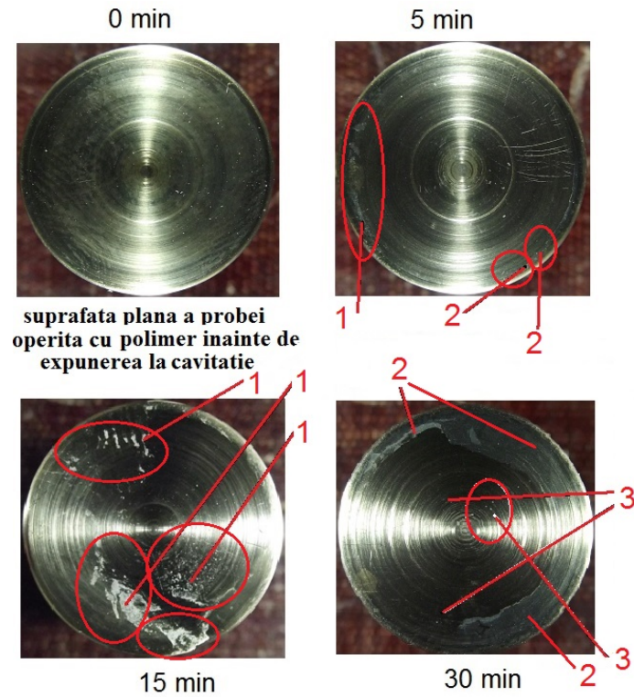
Fig. 5.26 Evoluția comportării la cavitația vibratoare a stratului de amestec de tip 5 depus pe proba 5.2
