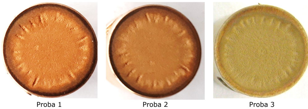
Fig. 4.24 Imagini macro (înregistrări aparat Canon A480) ale suprafețelor erodate prin cavitație vibratoare, timp de 165 minute
