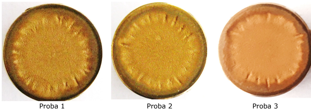
Fig. 4.15 Imagini macroscopice (înregistrări aparat Canon A480) ale suprafețelor erodate prin cavitație vibratoare, timp de 165 minute
