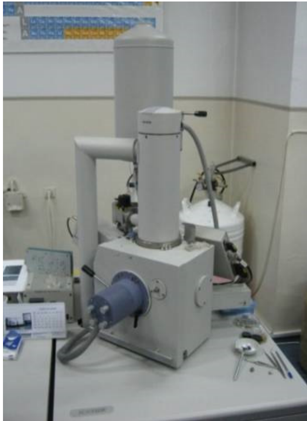
Fig. 2.12 Microscopul electronic cu baleiaj Philips XL 30 ESEM
