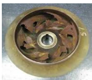
Distrus de cavitație
