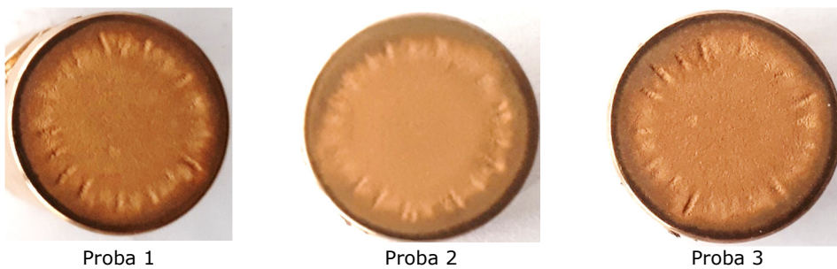
Fig. 4.33 Imagini macroscopice (înregistrări aparat Canon A480) ale suprafețelor erodate prin cavitație vibratoare, timp de 165 minute
