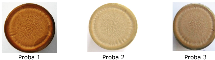
Fig. 3.18 Imagini macroscopice (înregistrări aparat Canon A480) ale suprafețelor erodate prin cavitație vibratoare, timp de 165 minute
