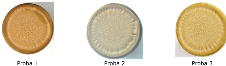
Fig. 3.6 Imagini macro (înregistrări cu aparat Canon A480) ale suprafețelor erodate prin cavitație vibratoare, timp de 165 minute
