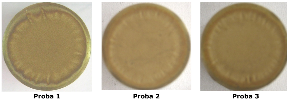
Fig. 4.48 Imagini macroscopice (înregistrări aparat Canon A 480) ale suprafețelor erodate prin cavitație vibratoare, timp de 165 minute
