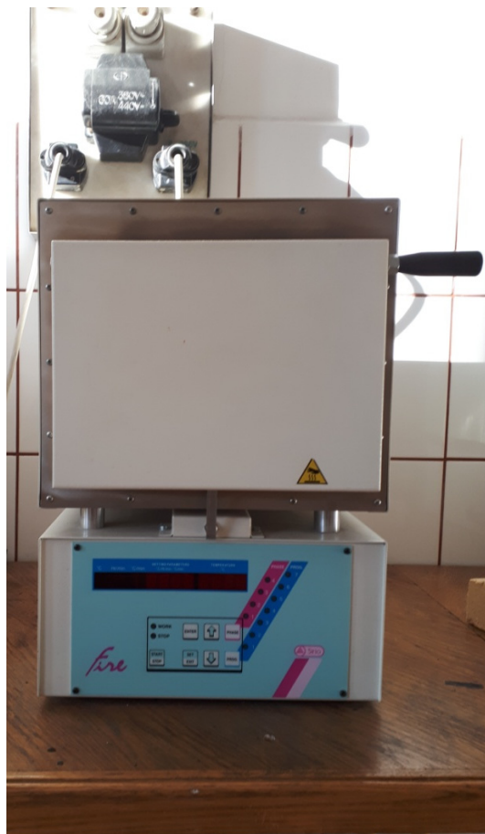
Fig. 2.9 Cuptor electric pentru tratamentele termice ale aliajelor metalice
