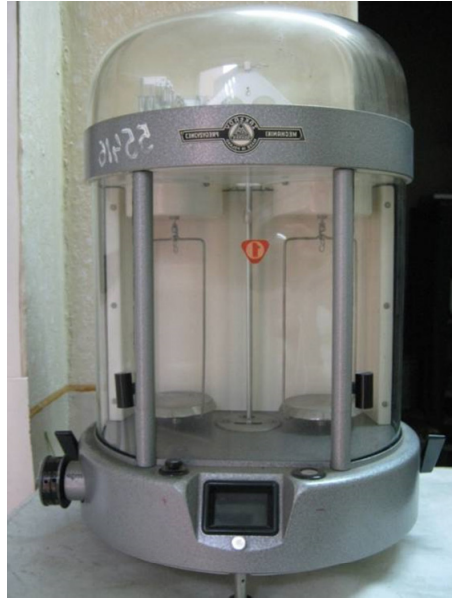
Fig. 2.5 Balanța analitică de tip Zařklady Mechaniki Precyzyjnej WP 11
