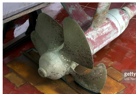
b) Elicea erodată de cavitație
