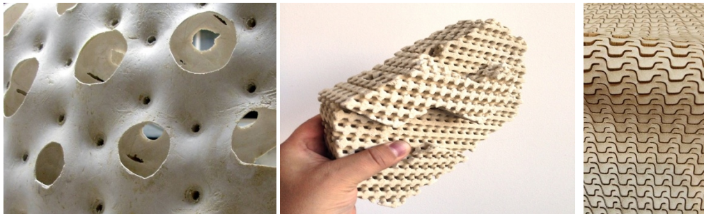
Fig. 4.43 (a) bloc poros de beton 142 (b)căramizi poroase 143 (c)coală din lemn asupra căreia s-au aplicat tăieturi pentru creșterea flexibilității 144
