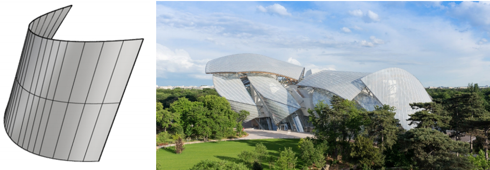
Fig. 2.36 Suprafață riglată desfășurabilă (desen propriu); Fundatia Louis Vuitton - arh. Frank Gehry, Paris, Franta, 2014 68
