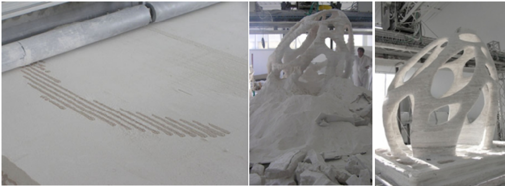
Fig. 5.22 Pavilionul Radiolaria realizat prin tehnica stereolitografiei arh. Shiro Studio architects, Pontedera, Italia, 2009 192
