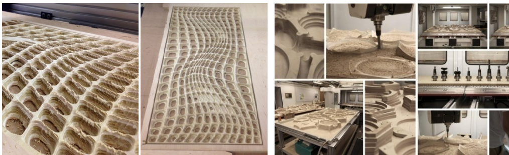
Fig. 5.20 (a) Frezare CNC de mică adancime Parametric Green Screen- arh. MLZDESIGN 190 ; (b) Descompunerea geometriei pe părți componente care după frezare sunt asamblate - La vouë de lefevre - arh.Matter Design, Ohio, USA, 2012 191
