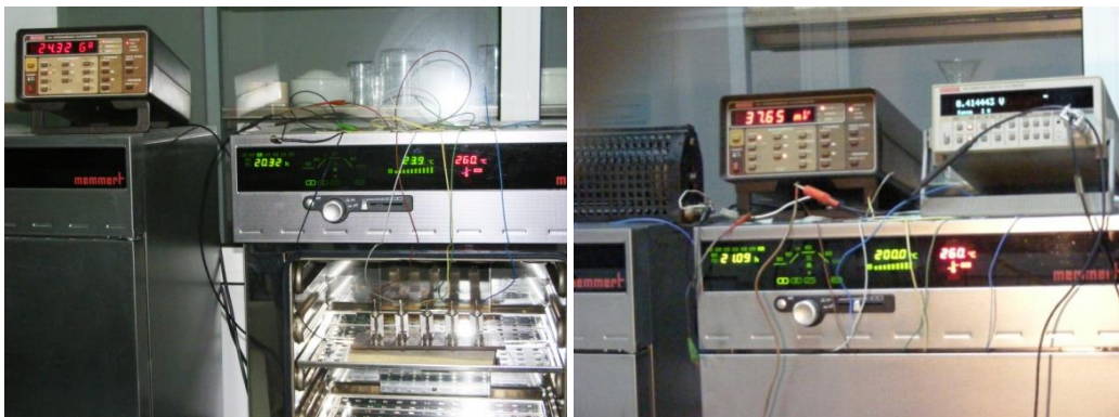
Figura 5.27. Stand de măsurare a variației rezistenței electrice cu temperatura
