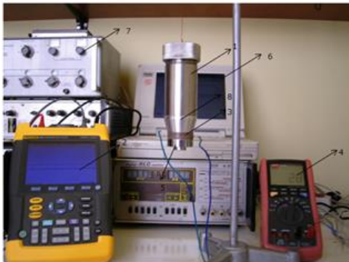
Figura 4.3. Instalatie experimentală de obținere a nanoparticulelor de Bi 2 Te 3 prin metoda hidrotermală asistată ultrasonic fără sonotroda imersată (autoclava este ultrasonată)
