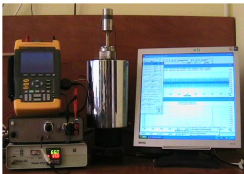
Figura 4.4. Instalatie experimentală de obținere a nanoparticulelor prin metoda hidrotermală asistată ultrasonică cu generator comandat de PC (pentru 40KHz)
