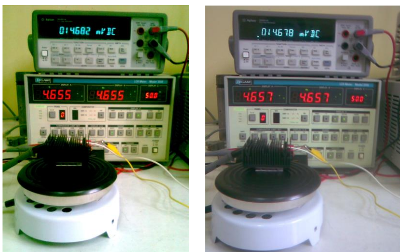
Figura 5.46. Testarea ansamblului dispozitiv termoelectric – sursă de căldură.
