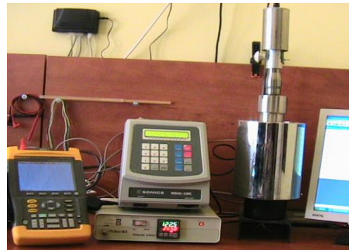
Figura 4.5. Instalatie experimentală de obținere a nanoparticulelor prin metoda hidrotermală asistată ultrasonică cu generator Cole-Palmer EW-04711-45, pe frecvență de 20 KHz împreună cu sistemele de achiziție și control
