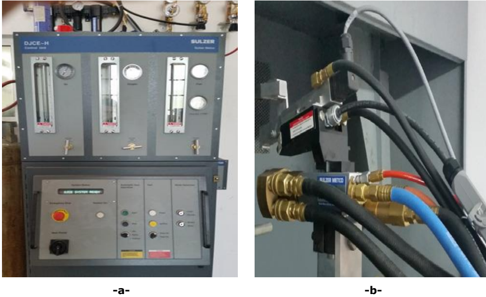
Fig.4.3 Echipamentul de pulverizare HVOF: a – modulul de comandă; b- pistolul DJM 2700
