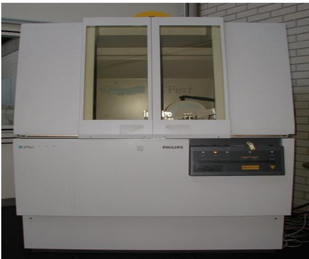
Fig. 3.27. Difractometrul de raze X ( X'Pert de la firma Philips)
