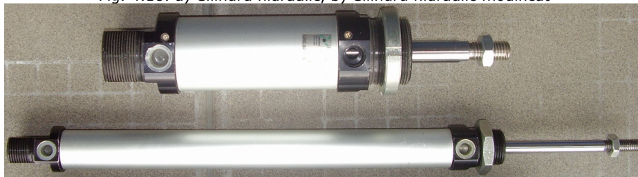
Fig. 4.18. a) Cilindru hidraulic, b) Cilindru hidraulic modificat
