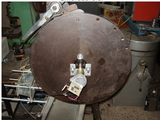
3.19. Traductorul incremental de măsurare a poziției unghiulare a pendulului atașat la axul pendulului
