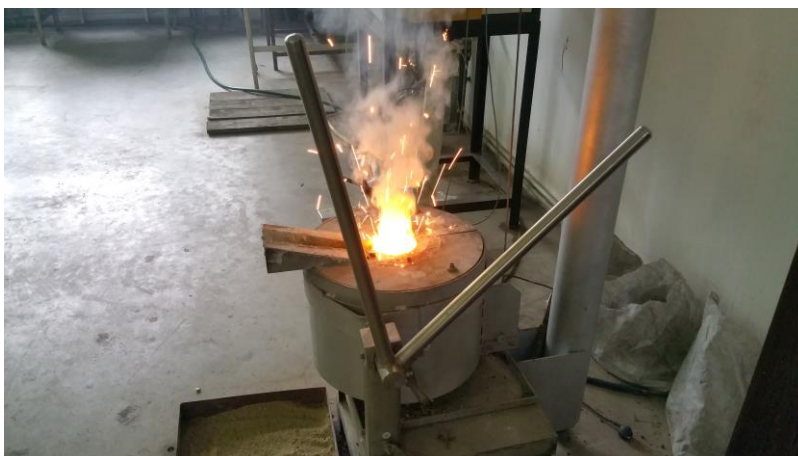
Fig.6.5 Adăugarea peletelor pe baia de oțelul lichid- Proba 1 (la 5 min după adaos)
