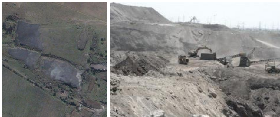
Fig.3.4 Depozitul de șlam de aglomerare-furnale rezultat pe platforma industrială a S.C. ArcelorMittal Hunedoara S.A. (Bataga) [1, 5]
