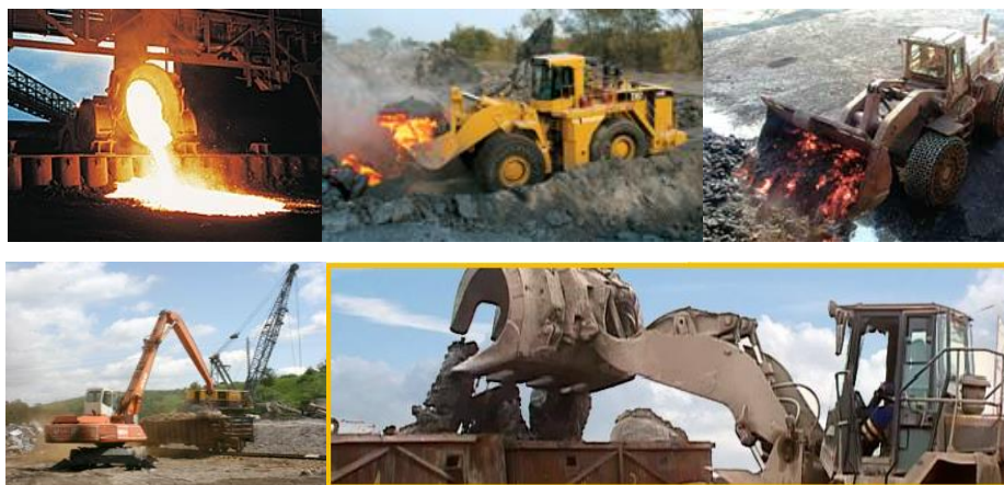
Fig.3.16 Instalații de primă mărunțire a zgurii [1]
