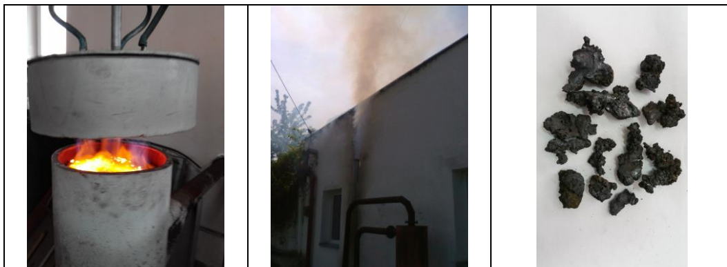
Fig.5.93 Aspecte din procesul de aglomerare: a) aprinderea șarjei; b) eliminare gaze cu oxid de zinc; c) aglomerat produs finit
