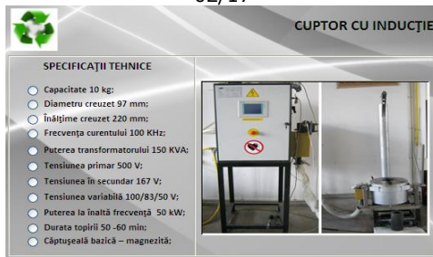
Fig.4.30 Cuptor de topire prin inducție
