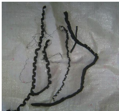
Figura 4.3.4. – Umplutură de șpan de oțel pentru filtrul de H 2 S [94]
