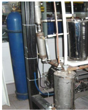
Figura 4.4.1 – Ansamblu sistem reținere CO 2 [95] Figura 4.4.2. – Compresor răcit cu aer [95]
