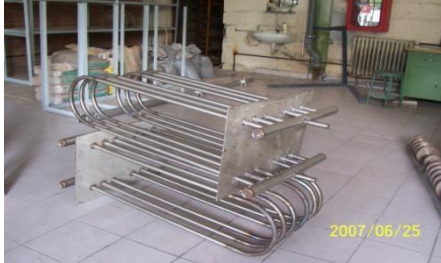
Figura 4.1.3.2. Schimbătoarele de căldură [ 94]
