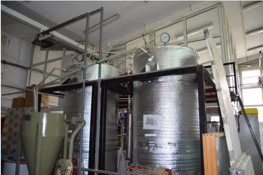
Figura 4.1.3.1. – Rezervoarele de fermentație anaerobă [92] [94]
