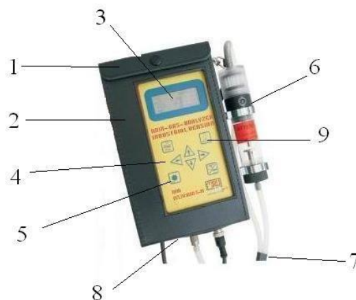
Figura 4.5.2.1. – Componenta analizorului Delta 1600 S IV [103] 1 – port conectare imprimantă externă, 2 – acumulator, 3 – afișaj, 4 – sistem de operare prin deplasare cu săgeți în meniul de control, 5 – comutator on – off, 6 – filtru captare picături apă, 7 – conexiune la sonda de prelevare gaz, 8 – conexiune la PC 9 – buton iluminare afișaj
