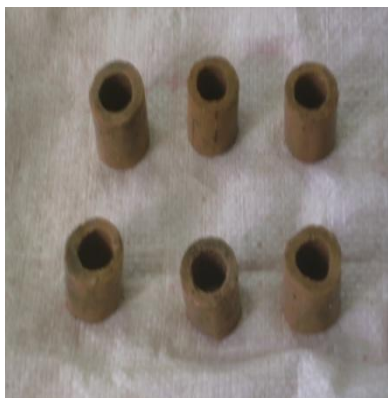
Figura 4.3.2. Inele ceramice Raschig folosită pentru filtrul [94] biogazului
