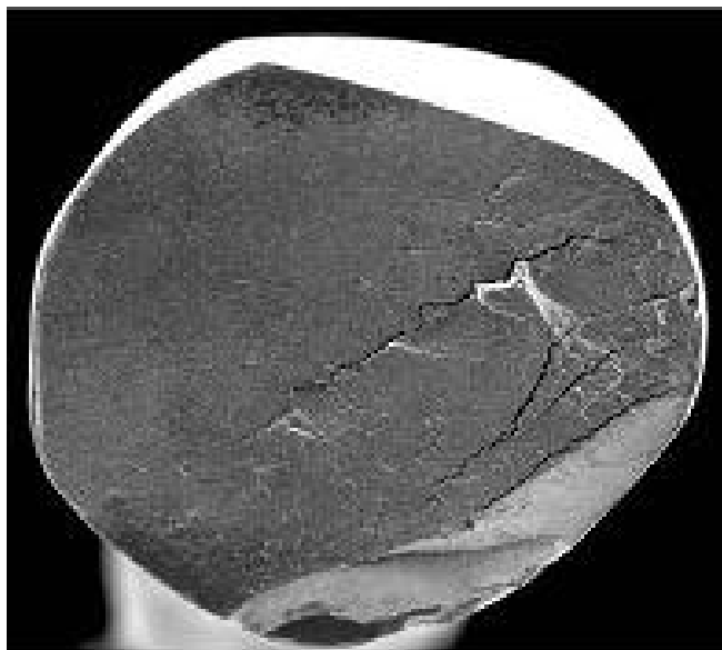
Fig. 4.33 Secțiunea sârmei ruptă la oboseală –[158]
