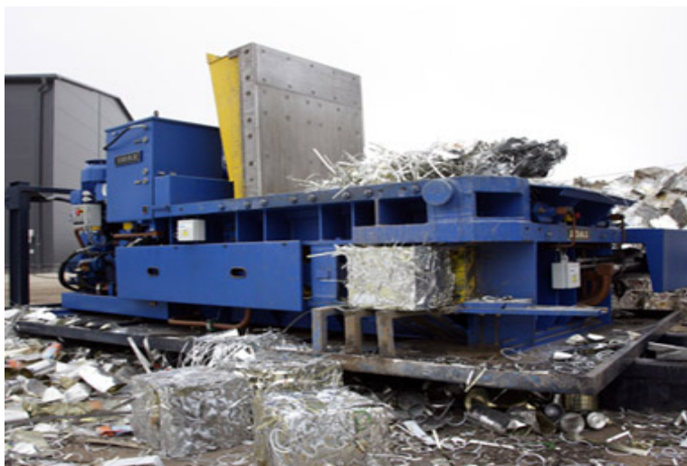
Figura 3.8.Presa de balotat fier vechi ușor
