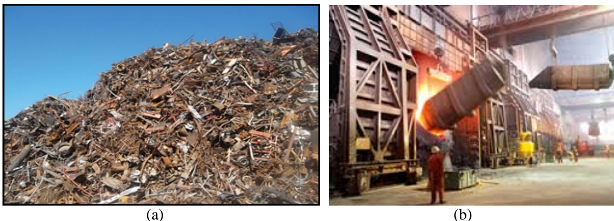
Figura 2.8.Utilizarea fierului vechi la convertizoarele cu oxigen (a) depozit; (b) încărcare
