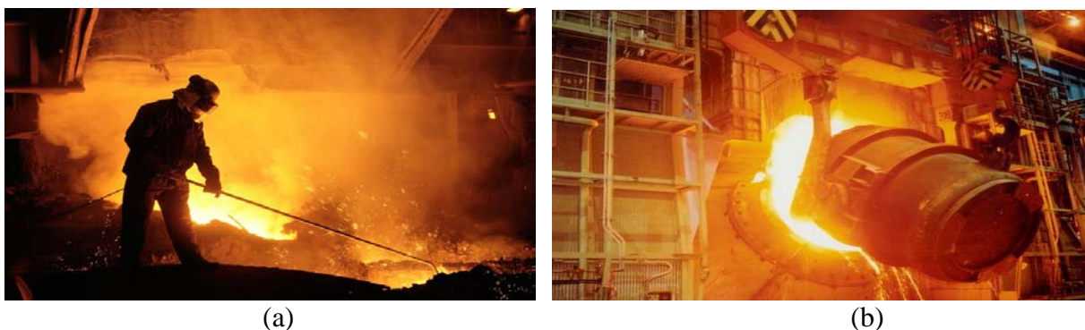
Figura 2.6. Evacuarea fontei din furnal (a) și încărcarea convertizorului cu oxigen (b)
