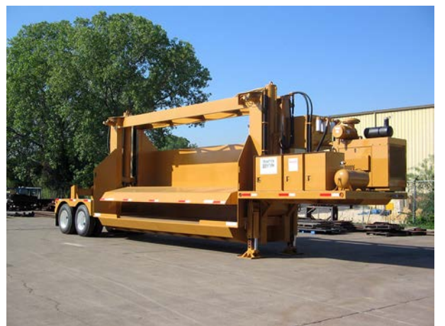
Figura 3.13. Macara mobilă pentru reciclarea automobilelor care se deplasează la locația beneficiarului
