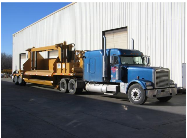
Figura 3.13. Macara mobilă pentru reciclarea automobilelor care se deplasează la locația beneficiarului
