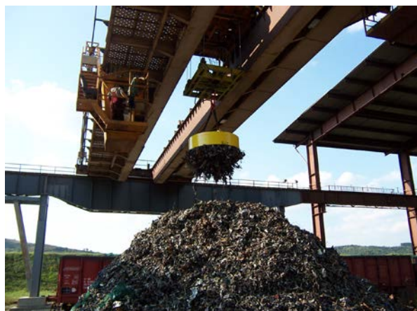
Figura 3.7. Utilaje pentru manipularea fierului vechi: a) graifer polip; b) graifer cu placă electromagnetice
