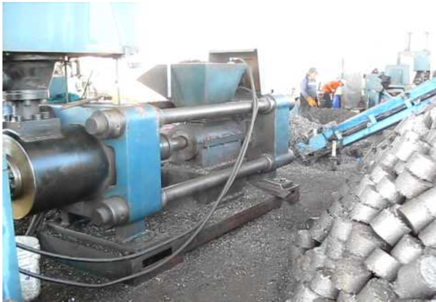
Figura 3.9. Instalație de brichetare așchii metalice
