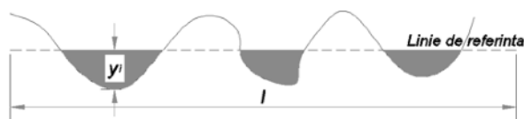
Figura 7.1. Măsurarea deviațiilor pentru calculul R_a
