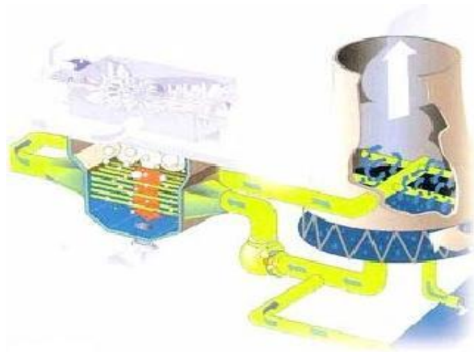
Fig. 1.8. Schema de circulație a apei de răcire de la condensator la turn.
