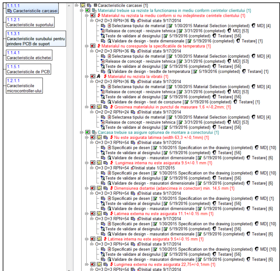
Fig. 4.37. Cauzele defectării la produsul de test
