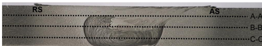
Figura 3.31. Amplasarea urmelor la măsurarea durității probelor sudate prin procedeul FSW
