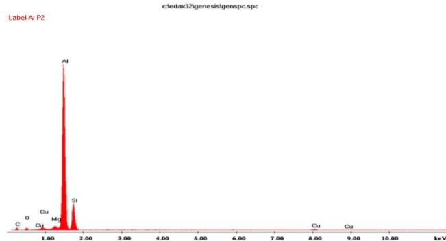
Figura 4.31. Imaginea SEM și diagrama EDS realizată în zona amestecată a îmbinării P6
