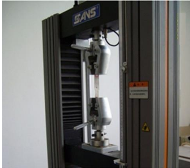
Figura 3.37. Setarea experimentului pentru încercarea la tracțiune a probelor sudate cu ultrasunete
