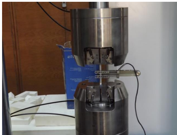
Figura 3.35. Pregătirea experimentului pentru încercarea la tracțiune a probelor sudate FSW
