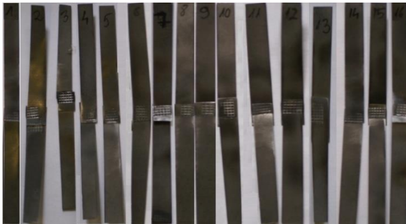
Figura 5.8. Aspectul macroscopic al probelor de AA2124/SiC/25p-T4, sudate cu ultrasunete
