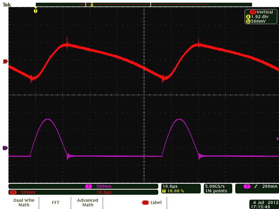
Fig. 5.11. Tensiunea de ieșire (roșu), și curentul prin bobina rezonantă (violet). Sursa [original].
