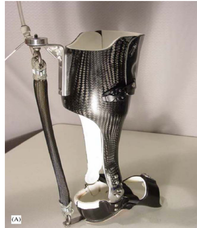
Fig. 3.18 Acționarea unei orteze de gleznă, cu ajutorul unui mușchi pneumatic [G6]
