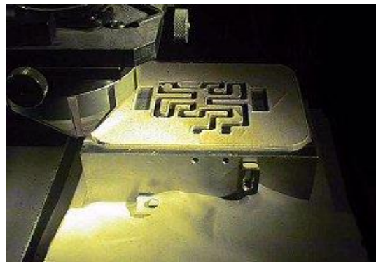
Figura 2.25. Matriță de injectat cu canale de răcire
