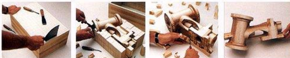
Figura 2.34. Înlăturarea structurilor de suport
