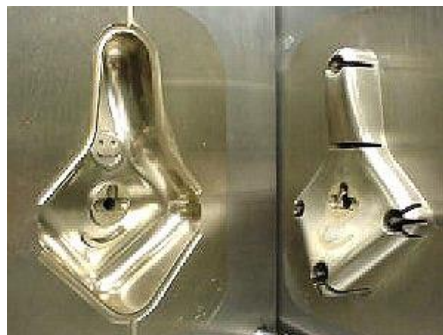
Figura 2.15. Insertie de oțel lustruit pregătit pentru injectare în matriță
