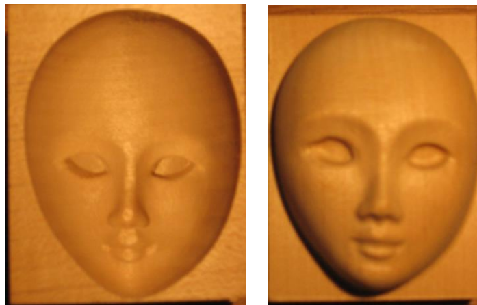
Figura 6.27. Forma finală realizată pentru reperul mască [DUM 008]
