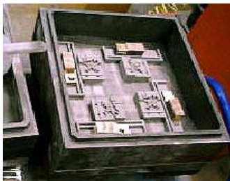
Figura 2.14. Insertii în creuzet pregătite pentru infiltrarea cu bronz
