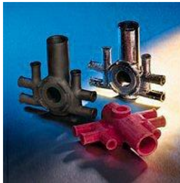
Figura 2.17. Modele de turnare și repere obținute în urma turnării
