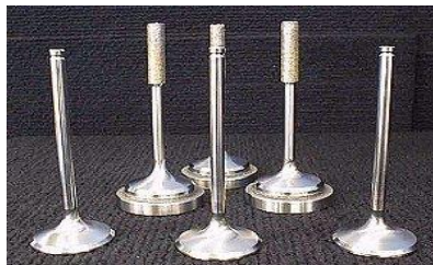
Figura 2.22. Valvele unui motor din titanium
