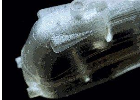
Figura 2.2. Suprafață rezultată prin stereolitografie
