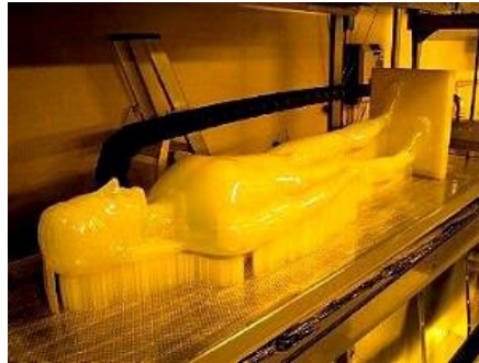
Figura 2.3. Statuie realizată prin stereolitografie
