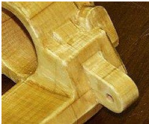
Figura 2.33. Suprafață finisată rezultat în urma laminării
