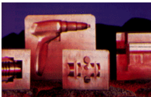
Figura 1.28. Miez și seturi de scobituri produse de Rapid Tool. [WTE 08]
