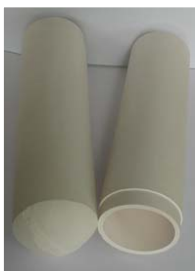
Fig.4.11. Membrană de \text{Al}_2\text{O}_3 depusă pe suport ceramic aluminos.
