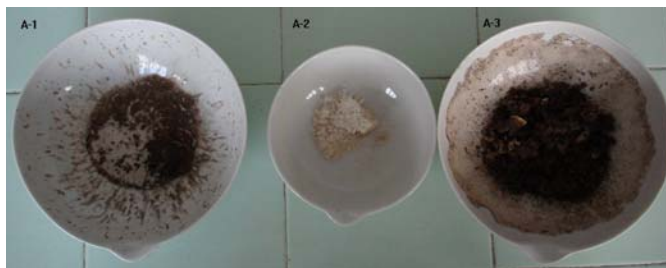
Fig.2.8. Imagini fotografice ale probelor obținute prin calcinare la 500°C timp de 1 oră.
