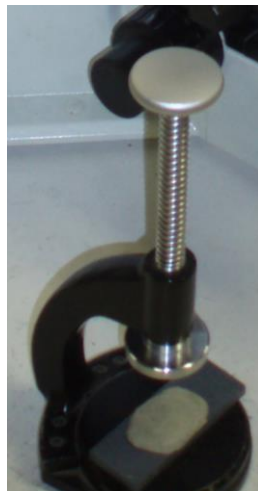
Fig.2.26. Presă pentru fixarea probelor în vederea examinării cu microscopul optic
