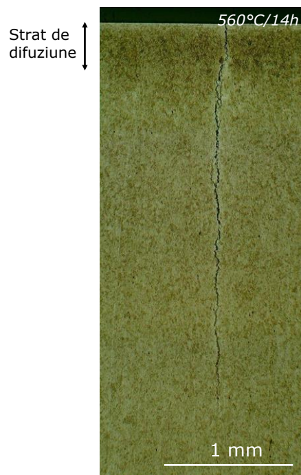
Fig.4.10. Fisură în epruveta nitrurată la 560^\circ\text{C}/14\text{h} . Atac Nital 2%, 50x
