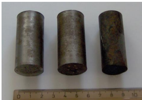
Fig.4.1. Probele \phi 21x10 mm și \phi 25x10 mm din oțel utilizate pentru confecționarea eșantioanelor în vederea nitrurării industriale
