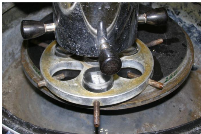
Fig.4.6. Instalația folosită pentru polizarea epruvetelor
