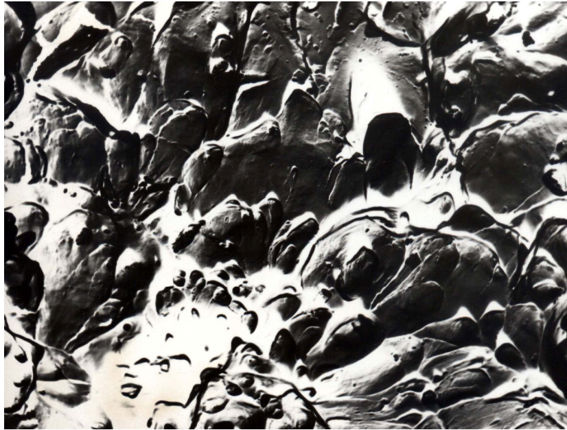
Figura 3.28. Imaginea microfractografică a unei epruvete testate la -20^{\circ}\text{C} , rupere ductilă
