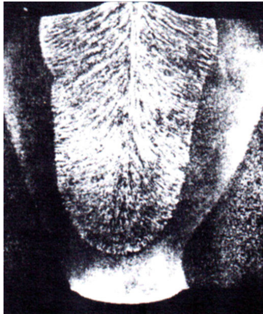
Figura 4.4. Imaginea macrografică a unei sudurii sub strat de flux în tandem; grosimea tablei 110 mm [5]
