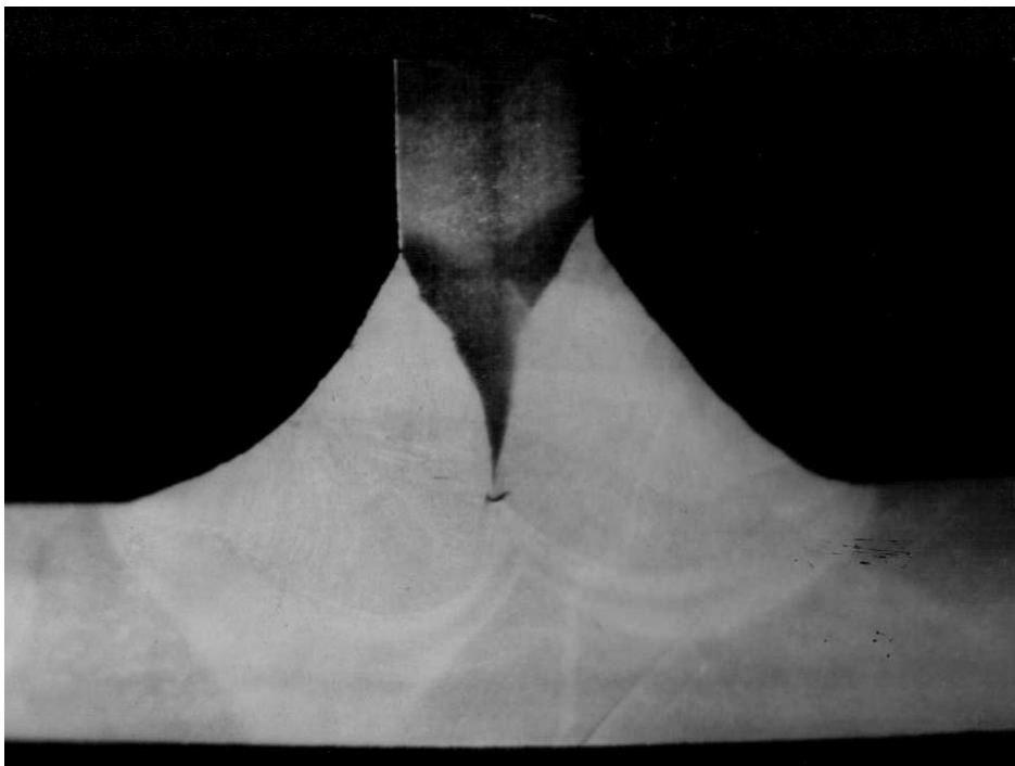
Figura 2.13. Imaginea macrografică a îmbinărilor cap la cap, rostul I, deschidere zero, s=10,5 mm
