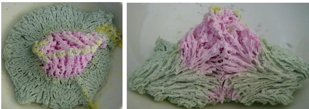
Figura 49. Pulberea de \text{Al}_{1.95}\text{Cr}_{0.05}\text{O}_3 obținută în urma reacției redox inițiată pe cuibul electric.
