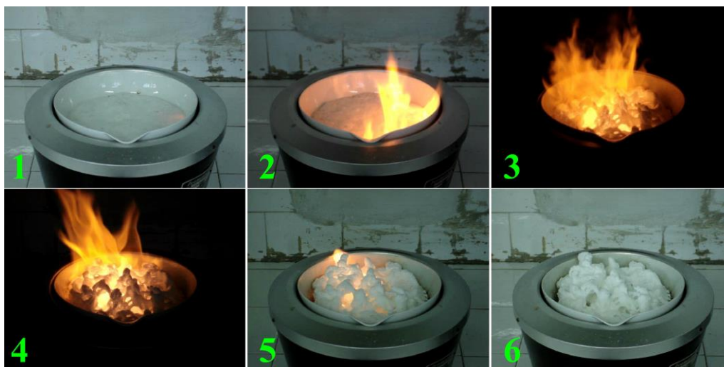
Figura 2. Reacția de combustie dintre \text{LiNO}_3 , \text{Al}(\text{NO}_3)_3 , uree și \beta -alanină.
