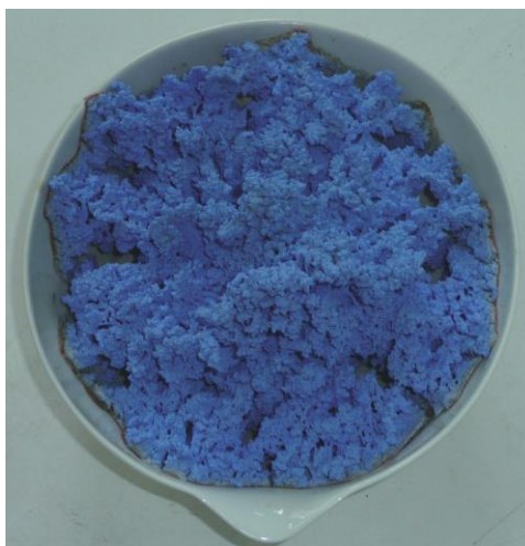
Figura 54. Pigmentul albastru ( \text{Mg}_{0.8}\text{Co}_{0.2}\text{Al}_2\text{O}_4 ) obținut prin combustie.
