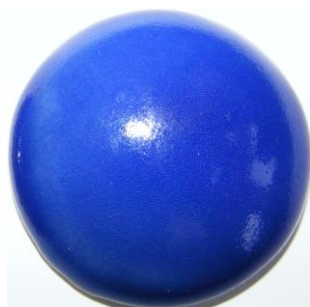
Figura 56. Mg_{0.8}Co_{0.2}Al_2O_4 testat în colorarea unei glazuri transparente de faianță de menaj.
