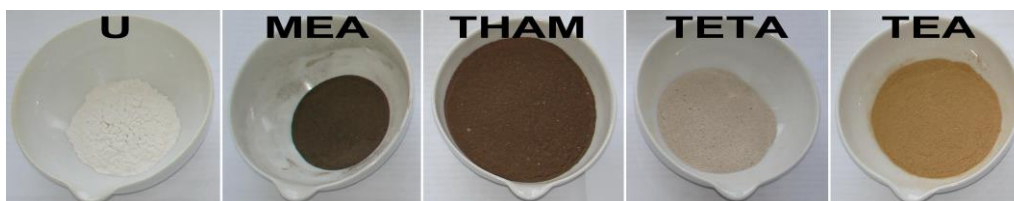
Figura 11. Pulberi obținute pornind de la Al(NO 3 ) 3 ·9H 2 O și diverși combustibili organici.
