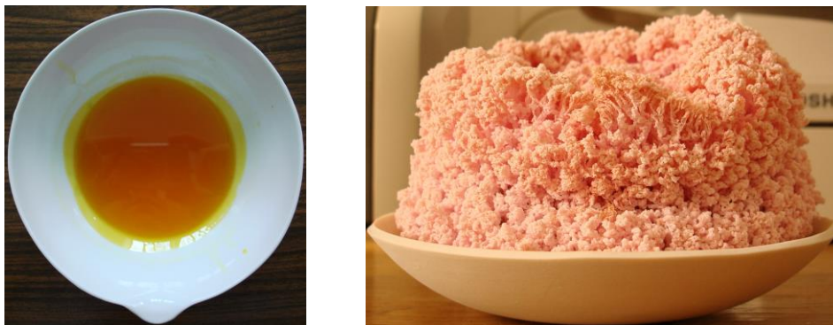
Figura 52. Amestecul precursor, respectiv pigmentul roz ( \text{ZnAl}_{1.95}\text{Cr}_{0.05}\text{O}_4 ) obținut prin combustie.
