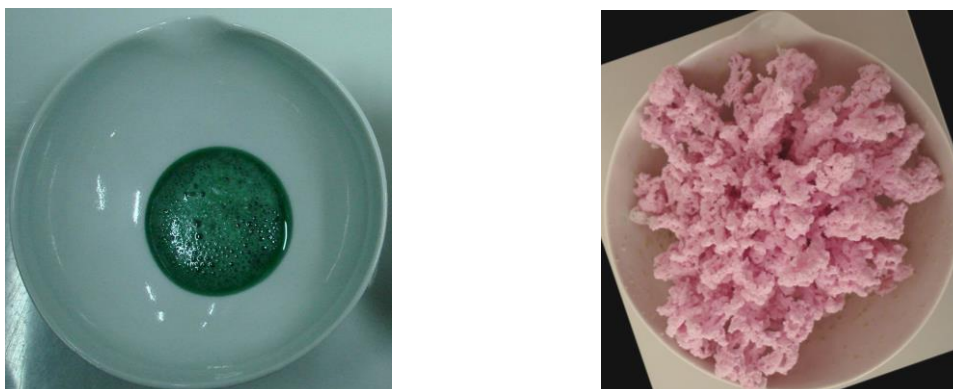
Figura 50. Amestecul precursor, respectiv pigmentul roz ( \text{Al}_{1.95}\text{Cr}_{0.05}\text{O}_3 ) rezultat din combustie.
