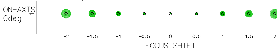
Fig. 5.60 Diagrama spot pentru sistemul cu obiectiv asferic la defocusări în intervalul \pm 2\text{mm}
