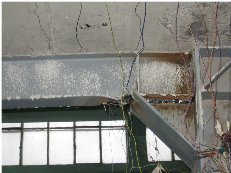
a. Voalare talpă inferioară capăt Est
