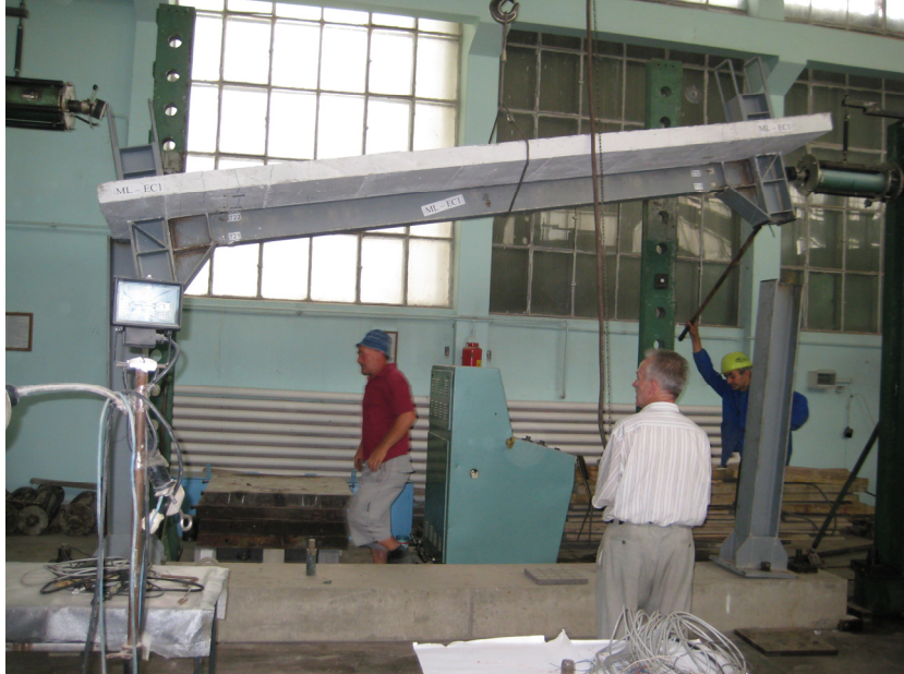
DEPLASARE PLACĂ CU PODUL RULANT
