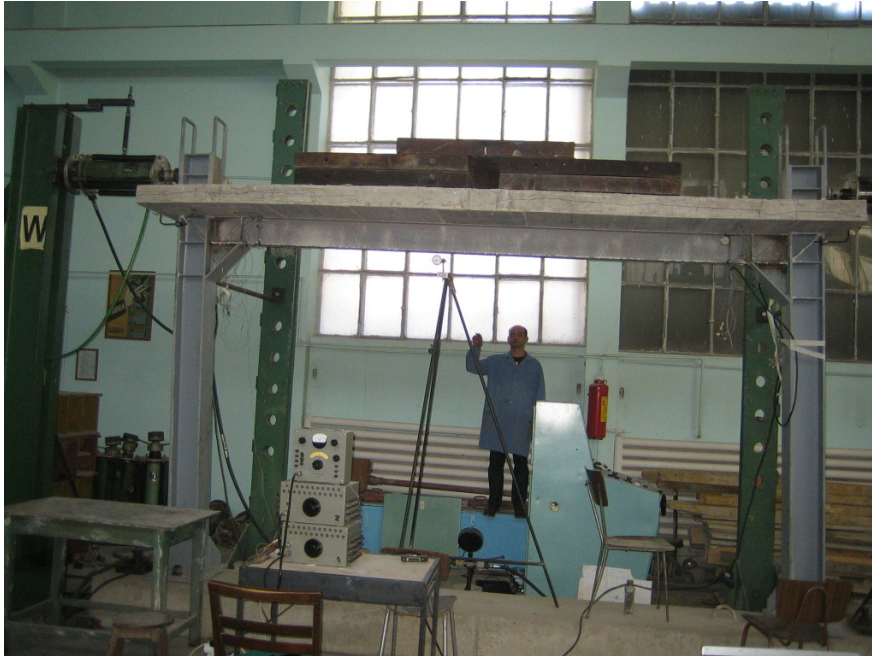
INSTALARE POMPE ȘI MICROCOMPARATOARE
