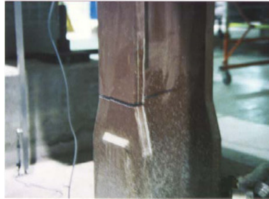
b. Ruperea transversală a stâlpului
