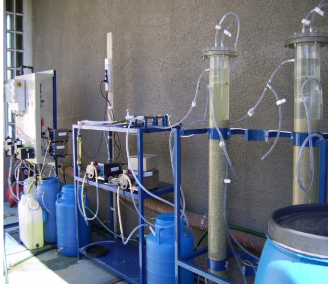
Figura 7.2. Imaginea instalației pilot de tratare a apei aerate prin procesul tehnologic de filtrare în două trepte cu zeolit și oxidare intermediară cu \text{ClO}_2 .
