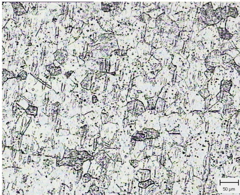
Figura 2.22 Substratul de titan mărire 100 x
