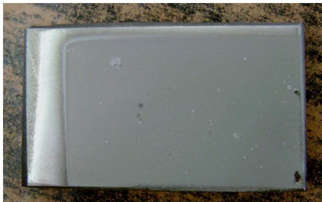
Figura 4.9 Imaginea stratului de hidroxiapatită depus pe substratul din aliaj de titan
