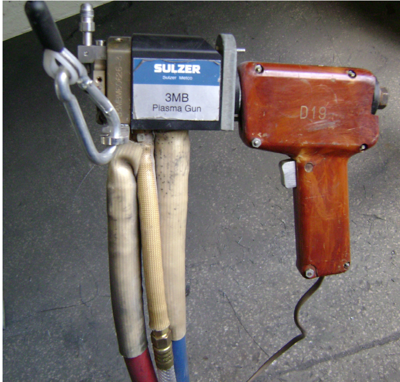
Figura 2.10 Pistolul de pulverizare 3MBM
