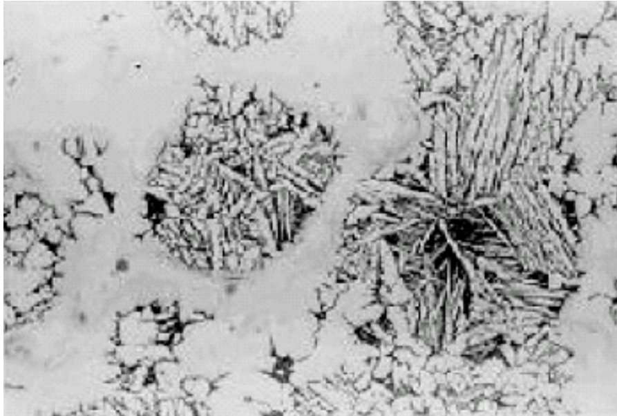
Figura. 1.8 Microstructura probei presate la 1100° C cu o presiune de 20MPa și viteză de încălzire de 20° C/min. Mărire 250 x [77]
