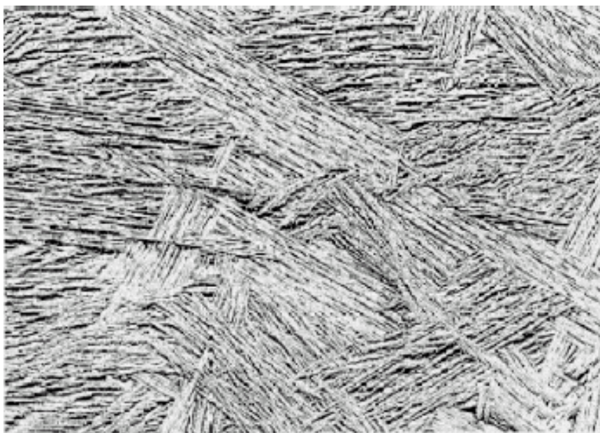
Figura 1.7 Microstructura probei presată la 1500° C cu o presiune de 20MPa și o viteză de încălzire de 20°C/min. Mărire 50x [77]
