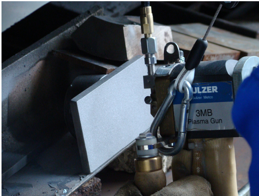
Figura 2.12 Instalația de pulverizare termică în jet de plasmă
