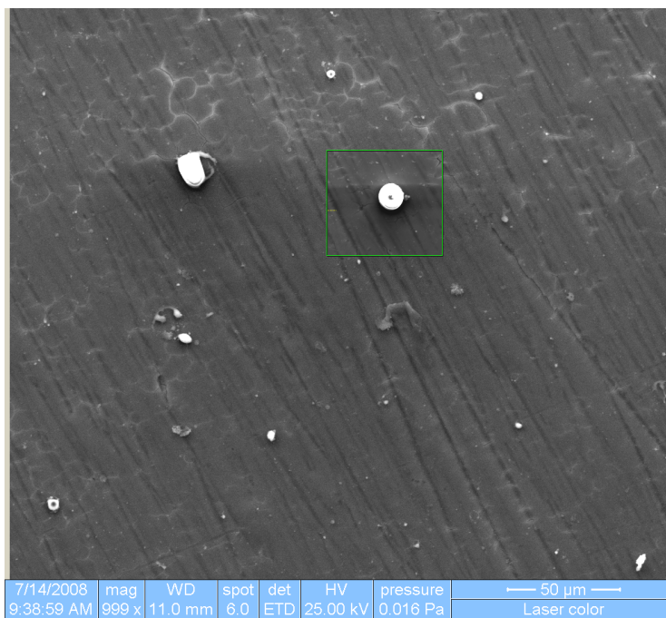
Figura 4.12 a, b, c Imagini efectuate la microscopul electronic cu baleiaj pe suprafața stratului de hidroxiapatită depus cu fascicul laser
