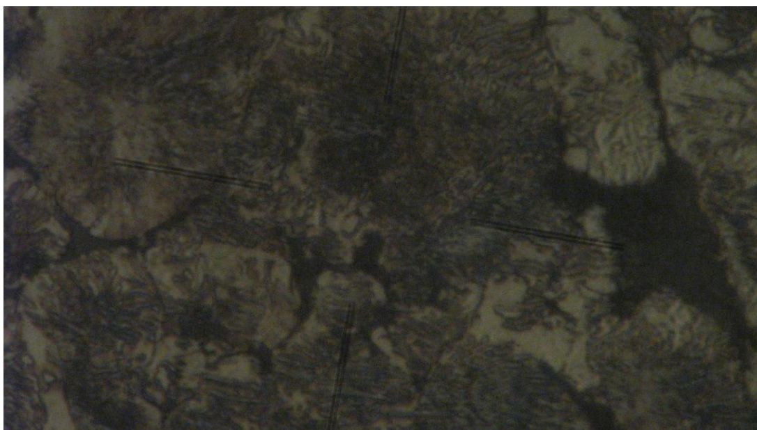
Fig.127 Textura cermet Fe+1 % MgO atacată cu nital 3 %, detaliu (x480)
