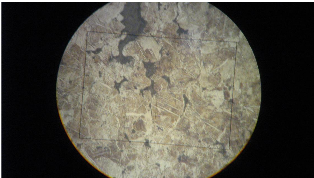
Fig.119 Textura cermet Fe+2 % Al 2 O 3 atacată cu nital 3 % (x120)
