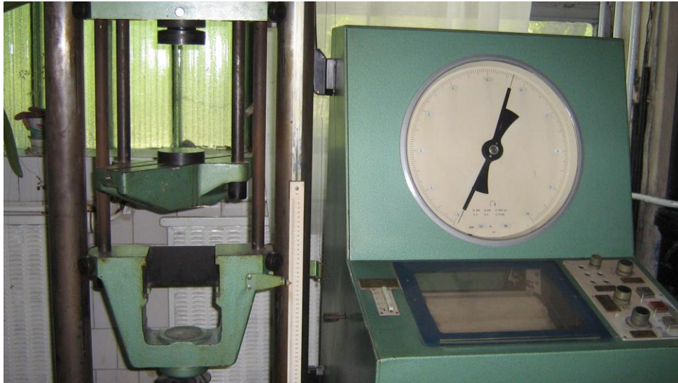
Fig. 24 Aparat utilizat pentru efectuarea încercărilor de tracțiune și compresiune
