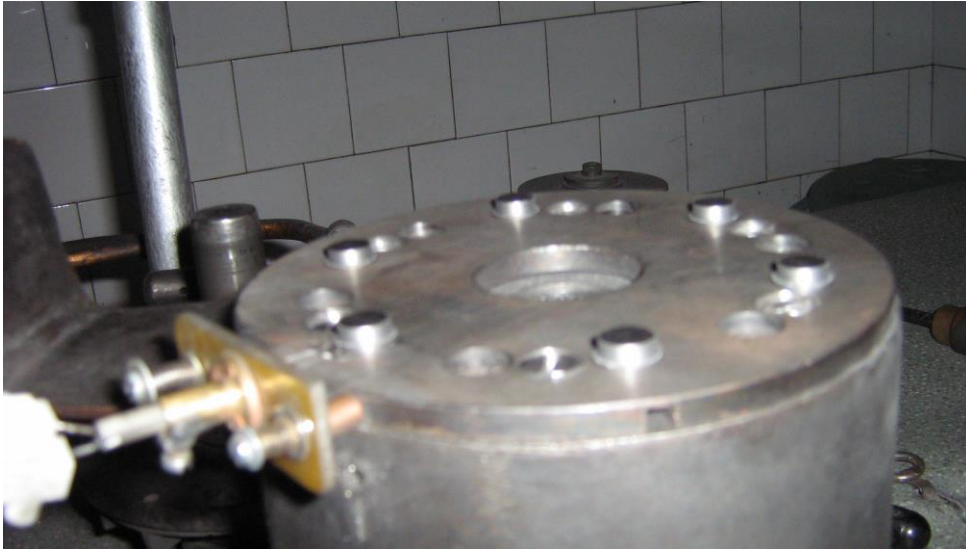
Fig.26 Dispozitivul de fixare al epruvetelor și termocuplu
