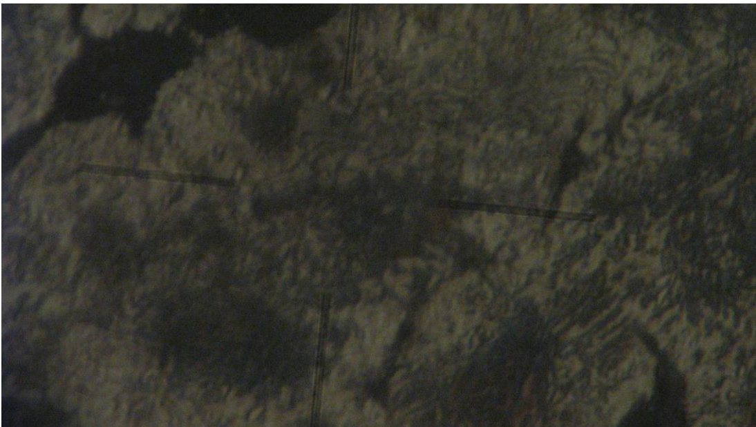
Fig.129 Textura cermet Fe+2 % MgO atacată cu nital 3 %, detaliu (x480)
