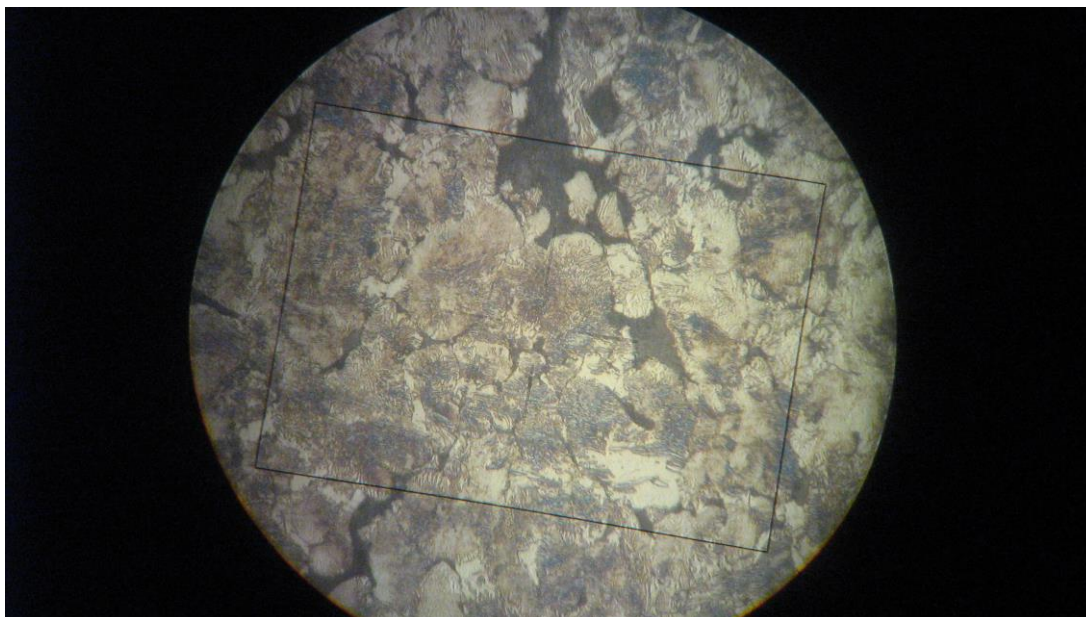
Fig.126 Textura cermet Fe+1 % MgO atacată cu nital 3 % (x120)
