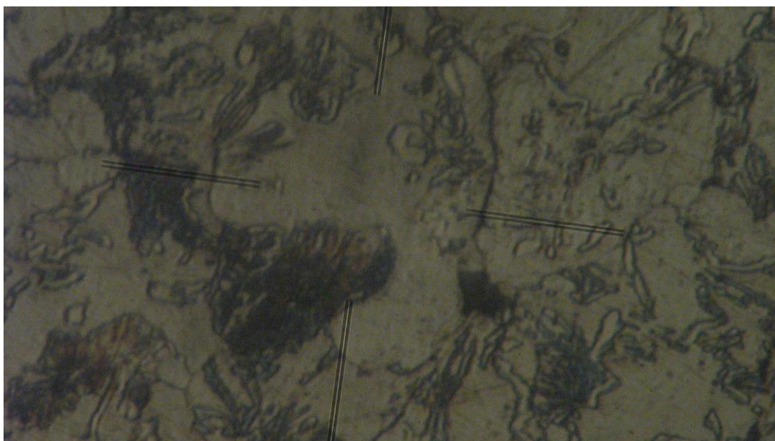
Fig.131 Textura cermet Fe+3 % MgO atacată cu nital 3 %, detaliu (x480)
