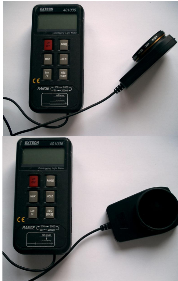
Fig. 4.26. Filtru atenuator montat pe senzorul de lumină al luxmetrului.(stand)
