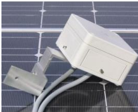
Fig. 2.12. Sistem de urmărire a traiectoriei soarelui [*****41].
