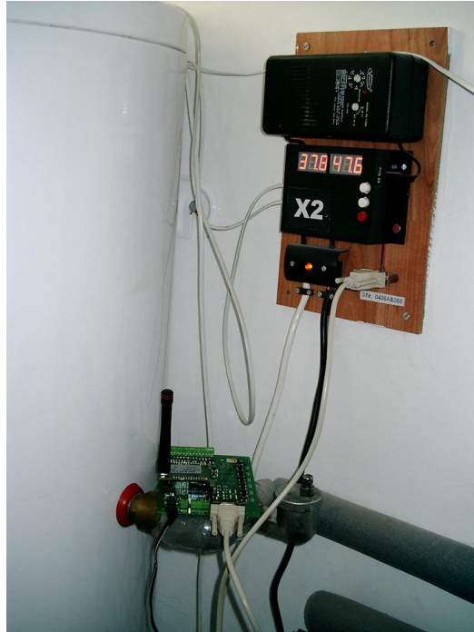
Fig. 5.7. Realizarea conexiunii între microcontroler și modulul IRIS 1.
