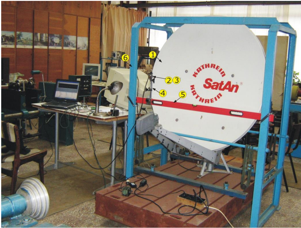
Fig. 5.8. Vedere de ansamblu al standului de testare la vibrații al antenei parabolice, cu sistemul de măsurare a vibrațiilor.
