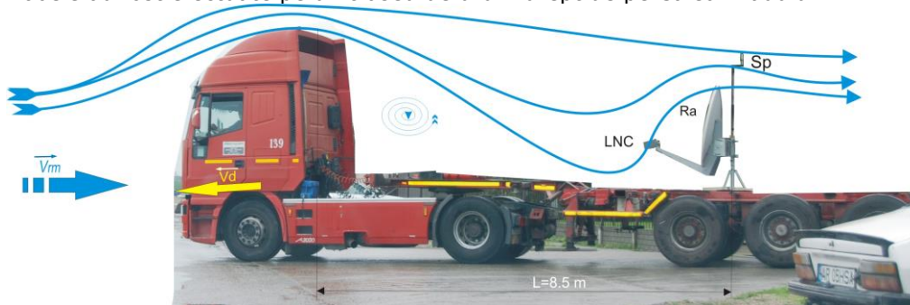
Fig. 5.29.1. Amplasarea antenei pe șaua trailerului IVECO în poziție longitudinală nerotită
