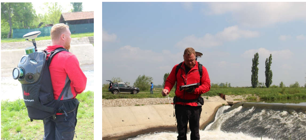
Fig. 4.48 Realizarea ZUPT-ului în timpul scanărilor obiectivelor de patrimoniu (Șmuleac A., 2019)
