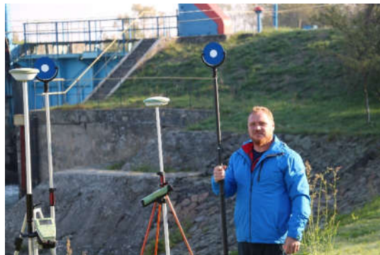
Fig. 2.13 Țintă 6 inch pentru ScanStation 3D Leica C10 (Șmuleac A., 2017)
