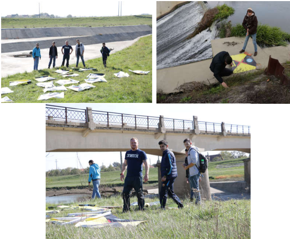
Fig. 4.137 Amplasarea punctelor de control-GCP (markerilor, țintelor) la sol (Șmuleac A., 2017)
