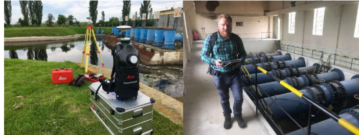
Fig. 6.4 Utilizarea rucsacului Leica Pegasus pentru scanarea Stației de Pompare Cruceni (Șmuleac A., 2019)
