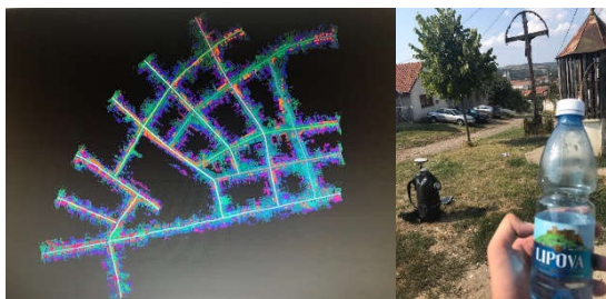
Fig. 6.8 Scanarea străzilor din Orașul Lipova cu Leica Pegasus Backpack (19 km) (Șmuleac A., 2019)
