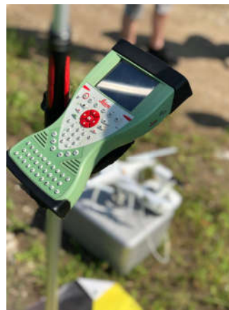
Fig. 4.139 Echipamentul GPS Leic GS08 folosit pentru determinarea coordonatelor țintelor
