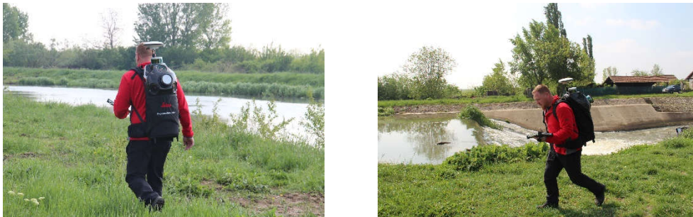
Fig. 4.46 Inițializarea dinamică realizată în vederea scanării Ecluzei de la Sânmihaiu Român (Șmuleac A., 2019)
