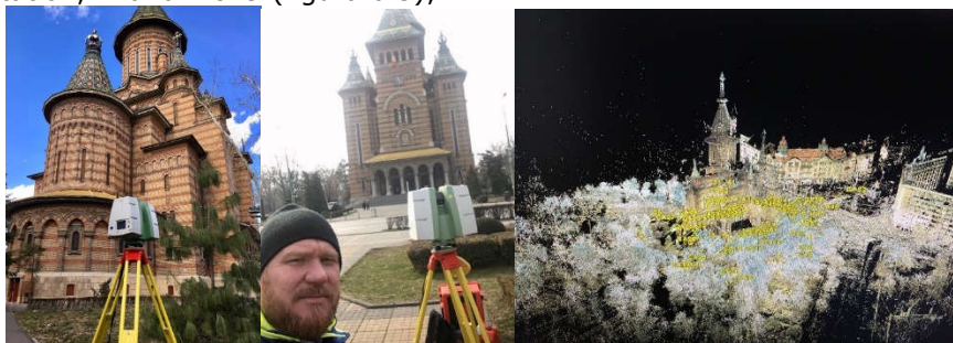
Fig. 6.3 ScanStation Leica C10 folosit pentru scanarea Catedralei Mitropolitane (Șmuleac A., 2019)
