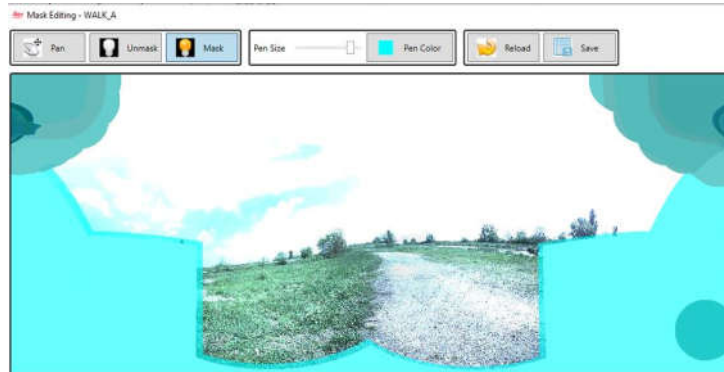
Fig. 4.73 După mascarea antenei GNSS (Șmuleac A., 2019)
