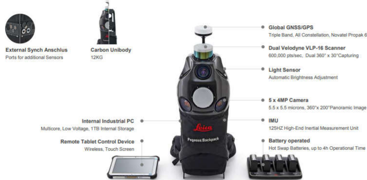
Fig. 2.25 – Descrierea echipamentului Leica Pegasus ( https://leica-geosystems.com/ )
