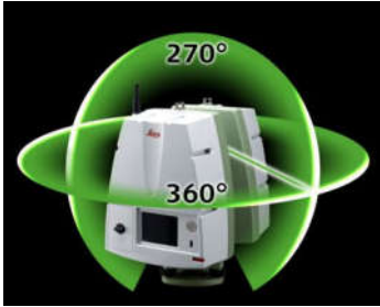
Fig. 4.21 Câmpul vizual de scanare pentru Leica C10 ( https://w3.leica-geosystems.com )
