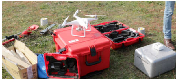
Fig. 2.20 Echipament UAV – Phantom4 Pro (Șmuleac A., 2019)
