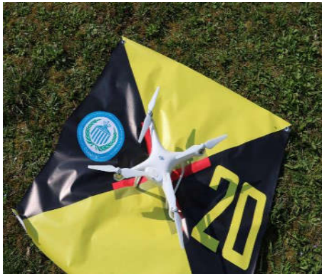
Fig. 2.22 Reperaj fotogrammetric (Șmuleac A., 2017)
