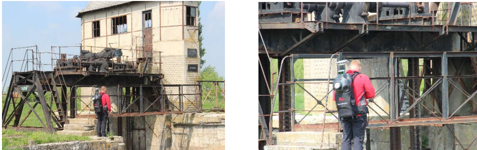
Fig. 4.47 Realizarea unui ZUPT în exterior în timpul scanării (Sânmihaiu Român) (Șmuleac A., 2019)
