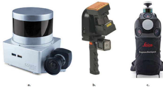
Fig. 1.20 Echipamente de scanare mobilă (a) Kaarta Stencil; (b) GeoSlam Zeb-Revo, (c) Leica Pegasus Backpack (Keller, F., Sternberg, H., 2013)
