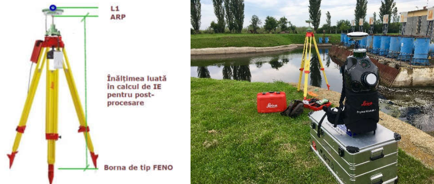
Fig. 4.52 Determinarea înălțimii stației de referință (Master) (Șmuleac A., 2019)
