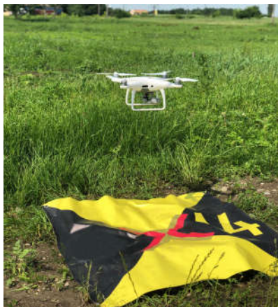
Fig. 4.138 Țintele (markerii) folosiți pentru georeferențiere (Șmuleac A., 2017)
