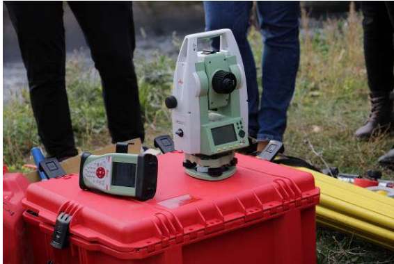
Fig. 2.8 Stația totală Leica TS02 (Șmuleac A., 2017)
