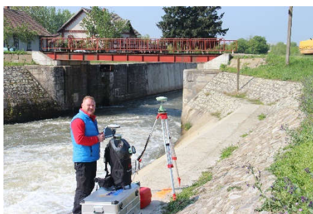
Fig. 4.44 Inițializarea Statică a rucsacului în vederea scanării (Șmuleac A., 2019)
