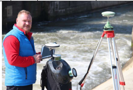
Fig. 4.53 Înregistrarea datelor Rinnex de la stația Master (Șmuleac A., 2019)
