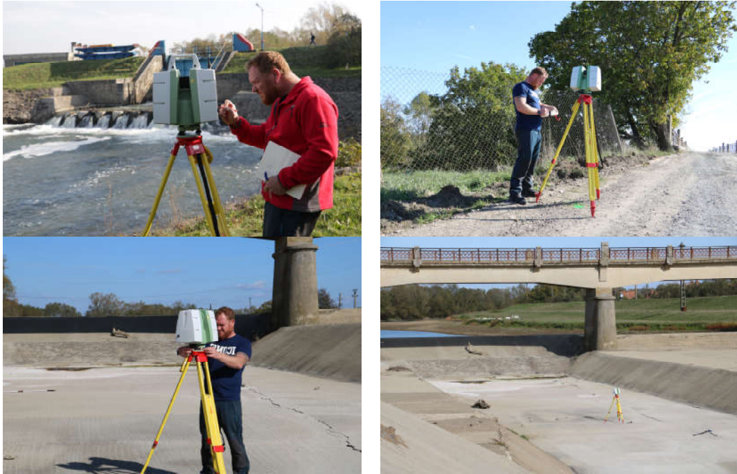
Fig. 4.23 Scanarea 3D a obiectivului - NH Topolovățu Mic (Șmuleac A., 2018)
