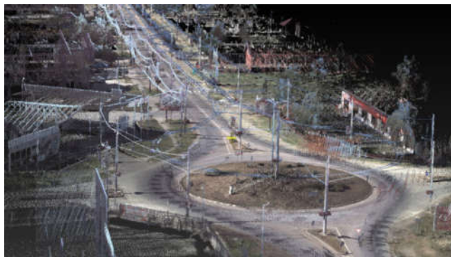
Fig. 6.9 Scanarea DJ691 Dumbrăvița de la sensul giratoriu aflat la intrarea în localitatea Dumbrăvița (Kaufland) până la sensul giratoriu de intrare pe autostradă (11+11 km) (Șmuleac A., 2019)
