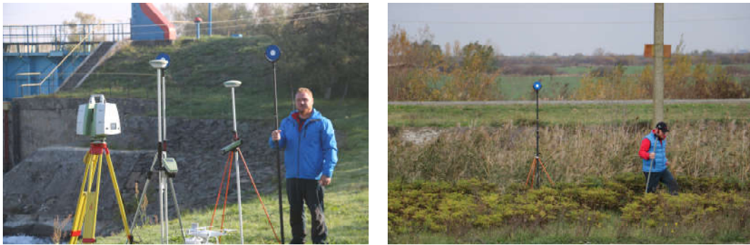
Fig. 4.25 Ținte de 6 inch utilizate la scanarea obiectivelor (Șmuleac A., 2018)
