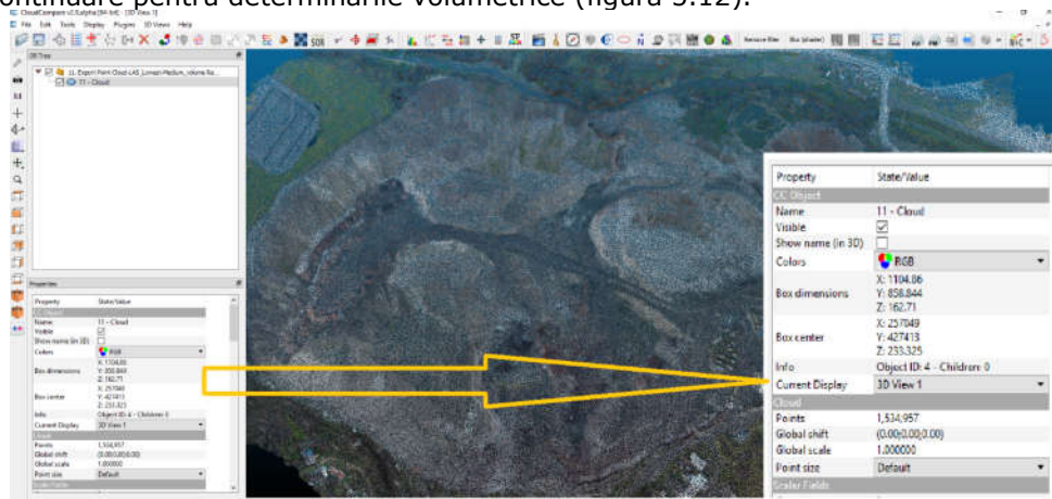
Fig. 5.12 Optimizarea norilor de puncte în CloudCompare (Șmuleac A., 2018)
