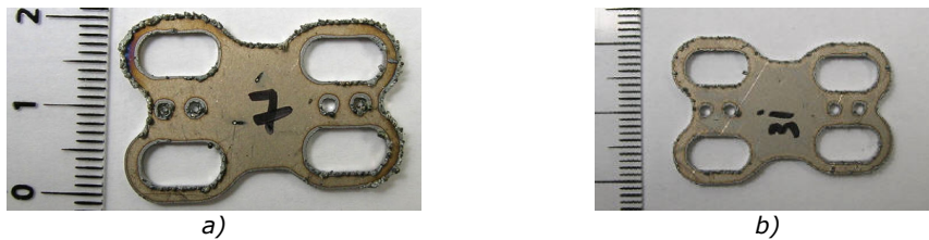
Figura 5.26 Subansamblul Sb1, vedere de jos: a) – parametrii necorespunzători, b) – parametri optimi
