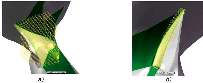
Figura 3.28 Exemple de reconstrucție a suprafețelor: a) – proces transvers, b) – proces spinos
