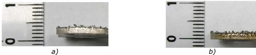
Figura 5.29 Aspectul prelucrării în regim pulsatoriu: a) – decuparea cu He a Sb2, b) – decuparea cu Ar a Sb3
