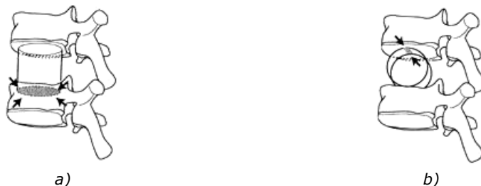
Figura 2.45 Tipuri constructive de implanturi cu interfațare cap la cap: a) – cu suprafețe plane, b) – cu suprafețe rotunde
